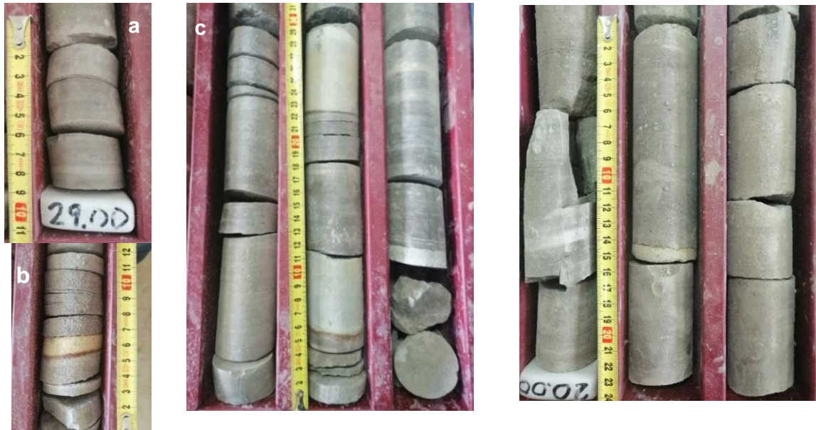
Figura 4.8. Muestras del testigo de perforación P-15 con estructuras sedimentarias. Litofacie Fsl1: a) Limolitas con intercalaciones de arenas laminadas de tonos grises claros. b) Limolitas con intercalaciones capas centimétricas de arcillas ocre y amarillentas con bordes oxidados c) Limolitas con capas de ceniza centimétricas. Litofacie Fm1: d) Limolitas con intercalaciones de lutitas gris claro a gris azulado y capas de ceniza centimétricas.
