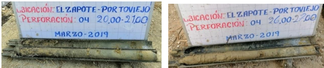
Figura 4.10. Muestras de la perforación PVS-4. La imagen de la izquierda corresponde a la litofacie Fsm1 y a la derecha la litofacie Fsm2.
