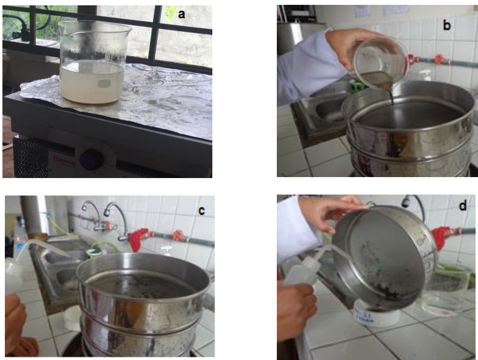
Figura 3.2. Preparación y tratamiento de muestras para el estudio de fósiles.
