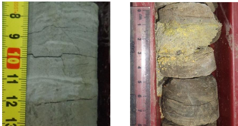
Figura 4.6. Muestras del testigo de perforación P-04 con estructuras sedimentarias. Litofacie Fsl2: a) Limolitas con intercalaciones de arenas gris claro. Litofacie Fsm2: b) Limolitas con intercalaciones de arcillas verde-amarillentas por presencia de azufre.
