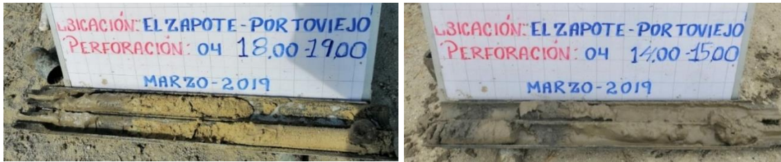
Figura 4.11. Muestras de la perforación PVS-4. La imagen de la izquierda corresponde a la litofacie Fsm3 y a la derecha la litofacie Fm2.
