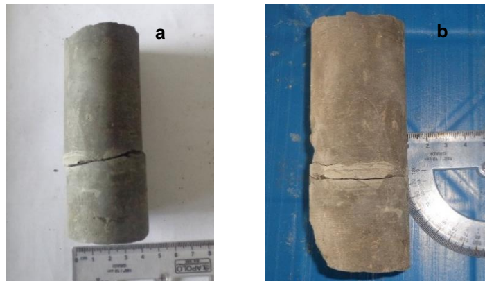
Figura 4.4. Limolitas del testigo P-04 de la Litofacie FI2 con bioturbación (a y b).
