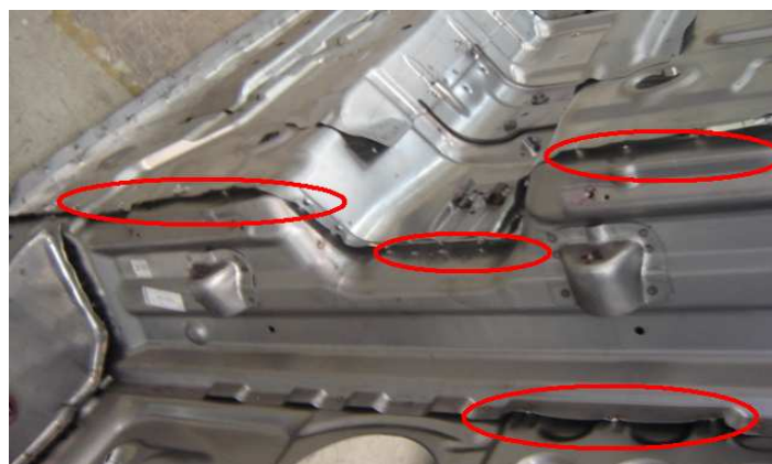
Figura 3.13 Discrepancia de calidad en piso delantero.
