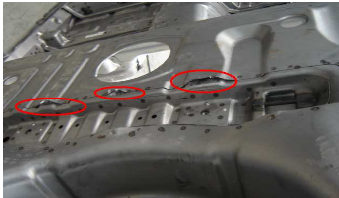
Figura 3.12 Discrepancia de calidad en piso posterior.
