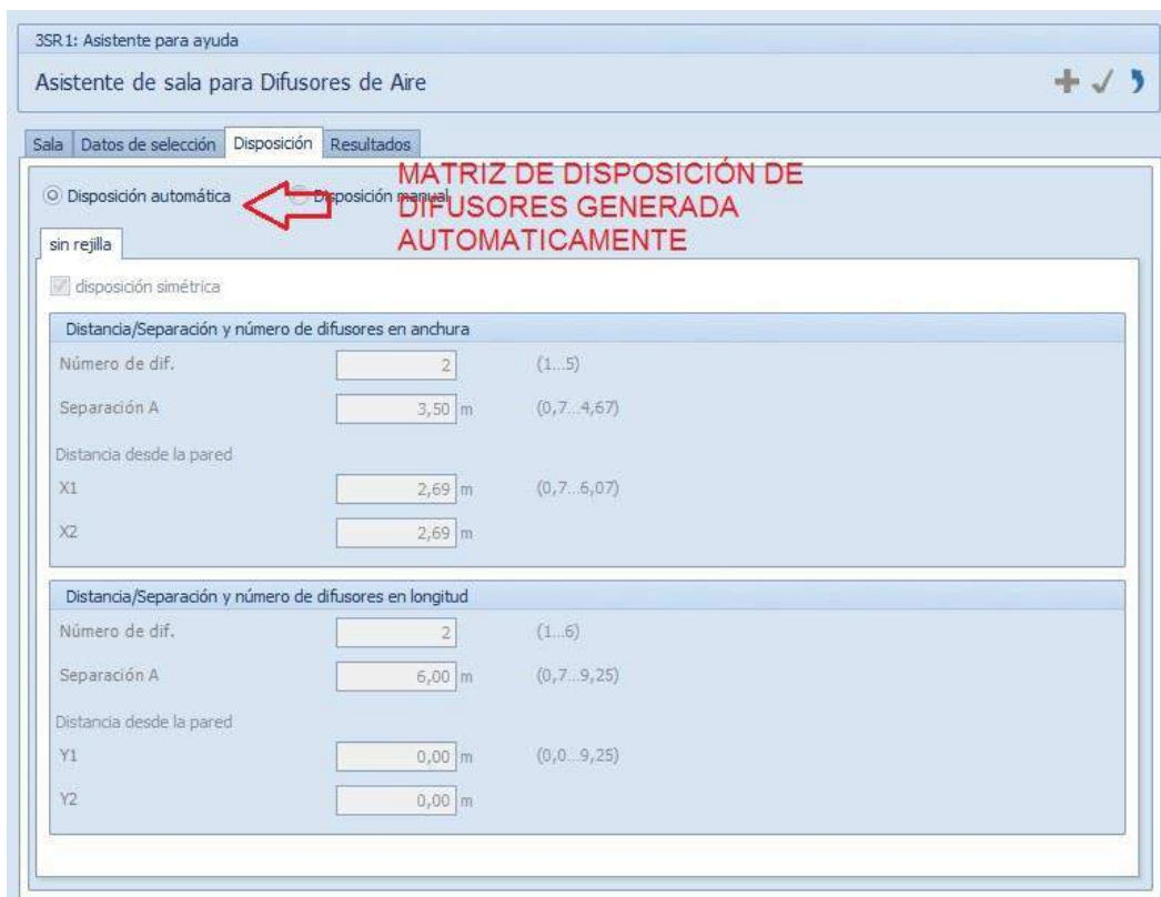
Figura 3.25. Paso 3; disposición de los difusores en el área 3SR1. Fuente: Propia, Hospital Enrique Garcés
