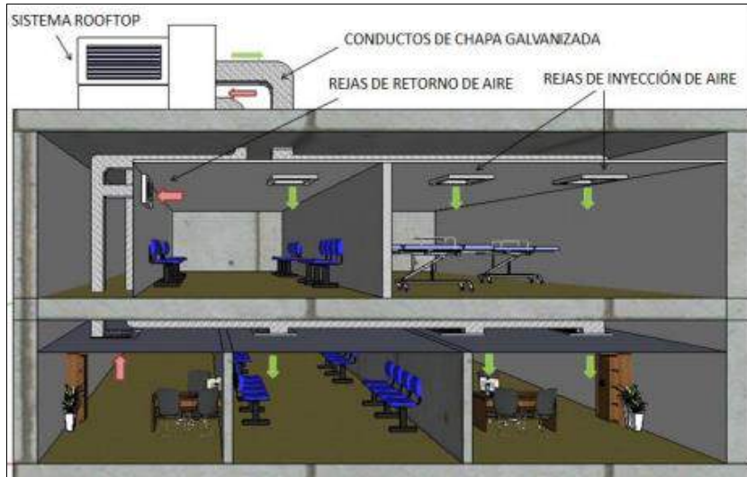
Figura 1.6. Esquema de un sistema “todo-aire” utilizando un equipo Rooftop. Fuente: (Luciana, 2016, pág. 19)
