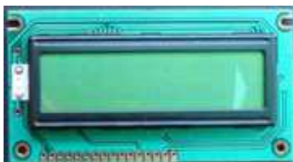
Figura. 1.18 Display LCD de texto de 16x2 con controlador HD44780
