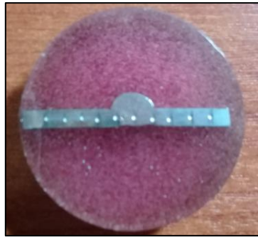
Figura 2.41. Puntos donde se mide la dureza de las muestras soldadas. (Fuente: Propia)
