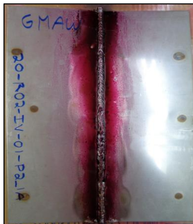
Figura 2.19. Placa soldada con proceso GMAW luego de aplicar el líquido penetrante. (Fuente: Propia)
