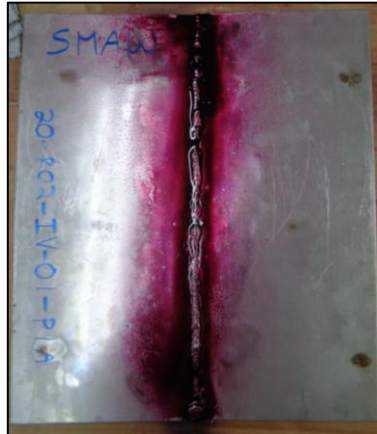
Figura 2.18. Placa soldada con proceso SMAW luego de aplicar el líquido penetrante. (Fuente: Propia)
