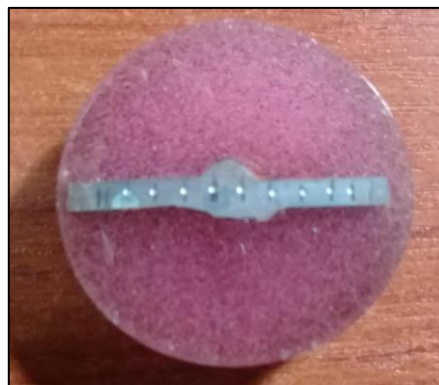
Figura 2.34. Muestra colocada en un disco de resina. (Fuente: Propia)
