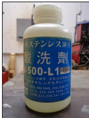
Figura 2.14. Gel decapante empleado para limpiar los cordones de soldadura. (Fuente: Propia)
