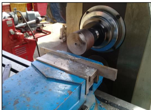
Figura 2.25. Maquinado de probetas en la fresadora de la MSB. (Fuente: Propia)
