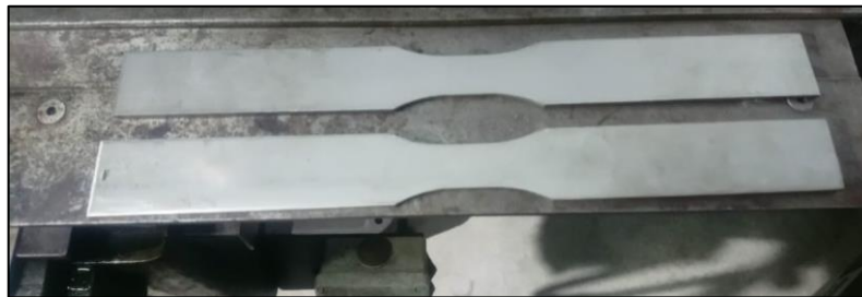
Figura 2.27. Probetas de material base para ensayo de tracción. (Fuente: Propia)
