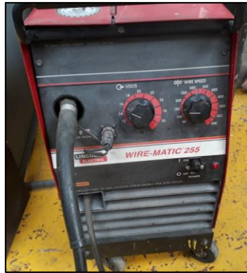
Figura 2.10. Soldadora para proceso GMAW. (Fuente: Propia)
