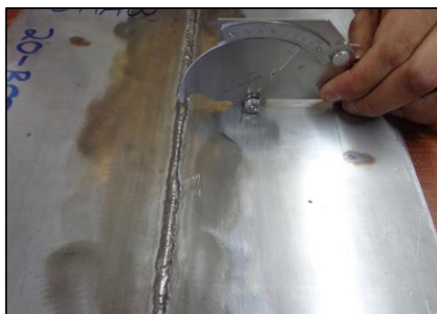
Figura 2.16. Medición de la sobremonta en el cordón de soldadura. (Fuente: Propia)
