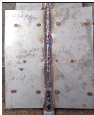
Figura 2.11. Junta soldada con proceso SMAW. (Fuente: Propia)
