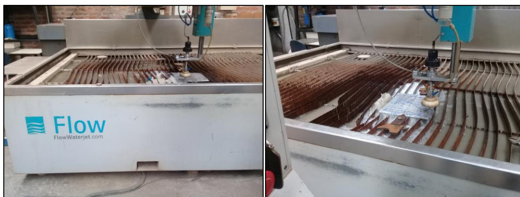
Figura 2.23. Corte de las probetas utilizando chorro de agua. (Fuente: Propia)
