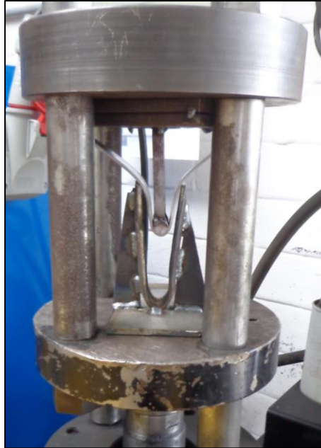
Figura 2.32. Ensayo de doblado en una de las probetas. (Fuente: Propia)
