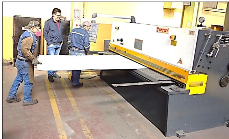
Figura 2.4. Corte de placas con cizalla hidráulica (Fuente: Propia)
