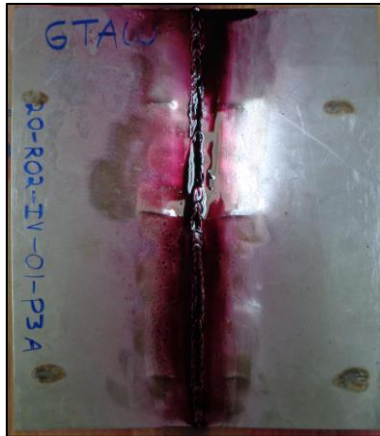
Figura 2.20. Placa soldada con proceso GTAW luego de aplicar el líquido penetrante. (Fuente: Propia)
