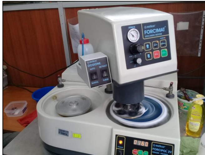
Figura 2.35. Pulido de las probetas. (Fuente: Propia)
