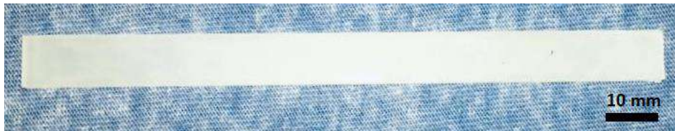
Figura 3.7. Probeta de flexión según la norma ASTM D790. (Fuente: Propia)
