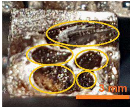
Figura 3.32. Sección transversal probeta sometida a tracción (Fuente: Propia)
