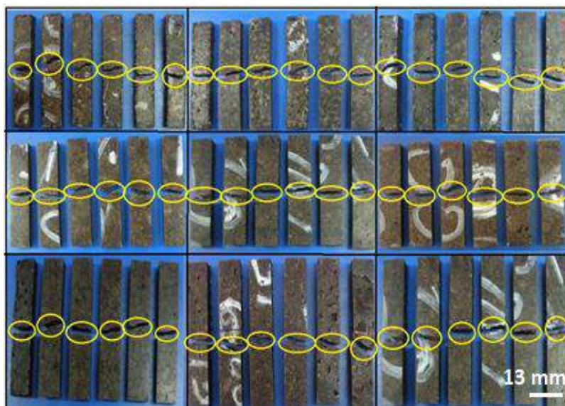
Figura 3.55. Fractura de todas las probetas sometidas a impacto. (Fuente: Propia)
