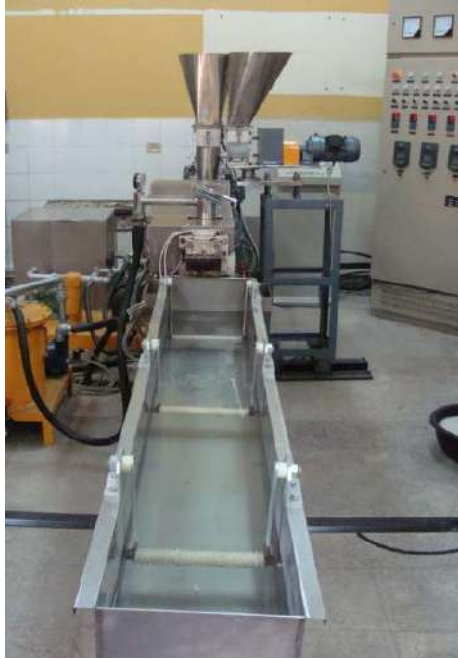
Figura 2.13. Extrusora XINDA PSHJ-35. (Fuente: Propia)
