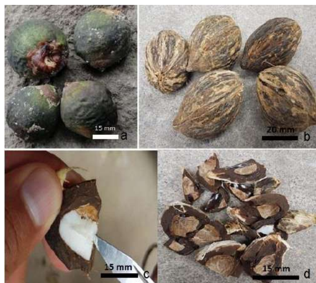
Figura 2.6. Pasos para la obtención del endocarpio de coco (EN). a) recolección, b) pelado, c) separación de la pulpa, d) producto final (EN)
