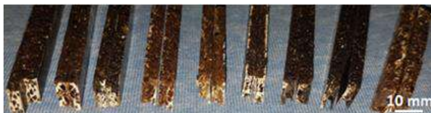
Figura 3.43. Sección transversal de cada composición del material compuesto ensayado a flexión. (Fuente: propia).
