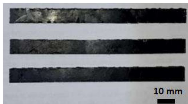
Figura 3.35. Condiciones finales de la probeta de los materiales compuestos sometidos a flexión. (Fuente: Propia)
