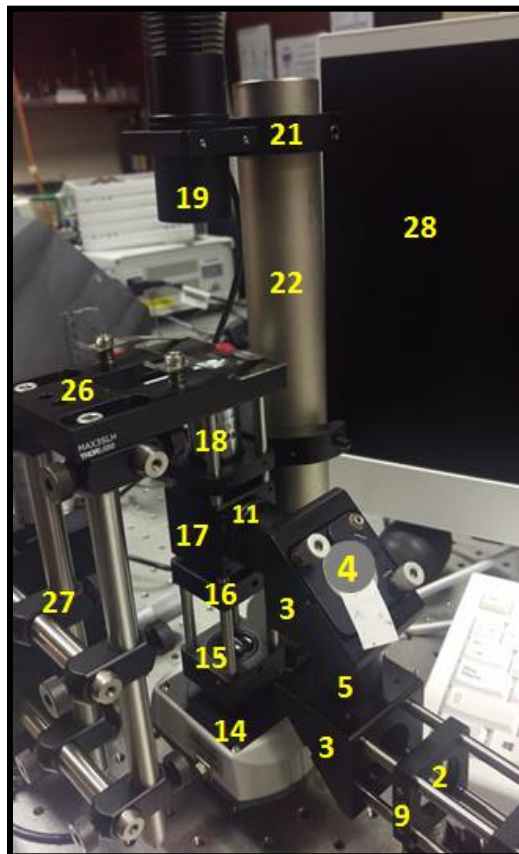
Figura 3.3 Sección (b) de enfoque y observación del sistema de pinza óptica
