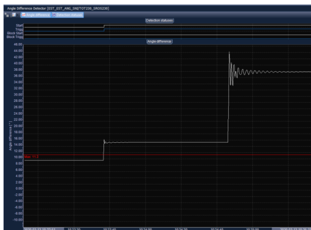
Figura F12. Visualización WAProtector – Diferencia Angular
