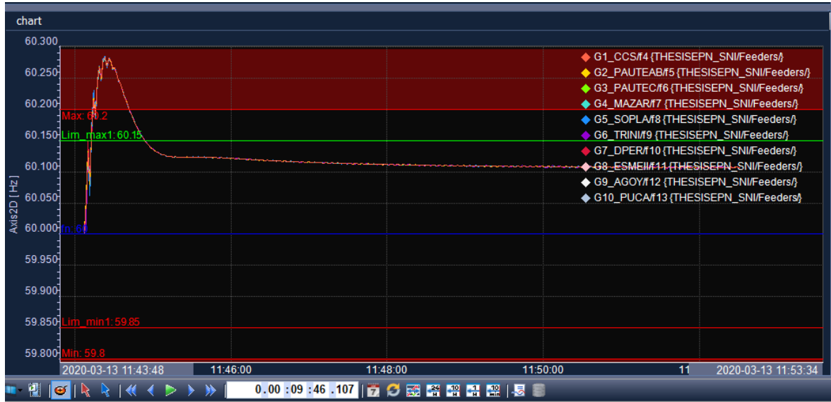
Figura 3.47. WAProtector Frecuencia [Hz] Generadores SNI - Desconexión Carga Pascuales
