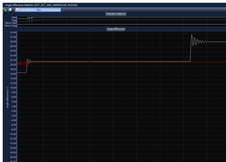
Figura 3.43. WAProtector Diferencia Angular Molino 230 kV – Pascuales 230 kV - (Operación Normal, N-1 Circuito 1 Molino – Pascuales 230 kV, N-2 Circuito 2 Molino – Pascuales 230 kV)
