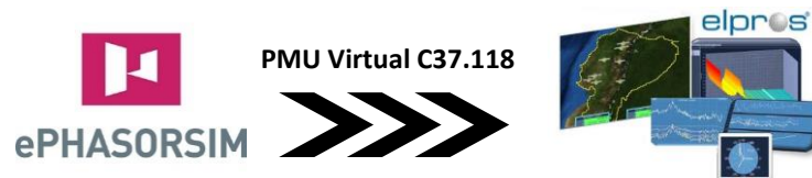
Figura 2.18. Conexión ePHASORsim – WAProtector
