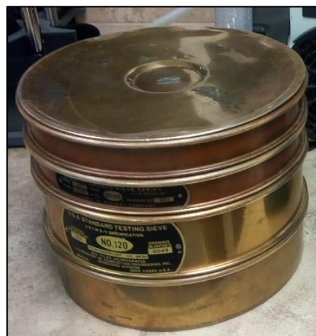
Fotografía 4. Tamizado de la cáscara de maní en tres diferentes granulometrías
