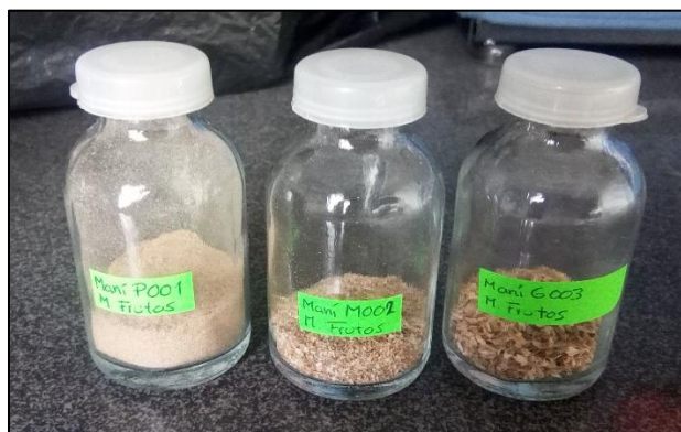
Fotografía 5. Granulometría de las partículas
