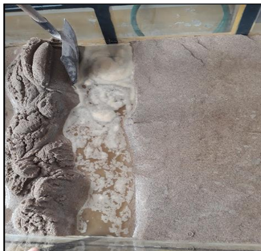
Figura 3-15 Remoción del sedimento para colocar los paneles
