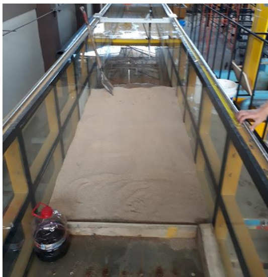
Figura 3-24 Capa de sedimento en la sección de control
