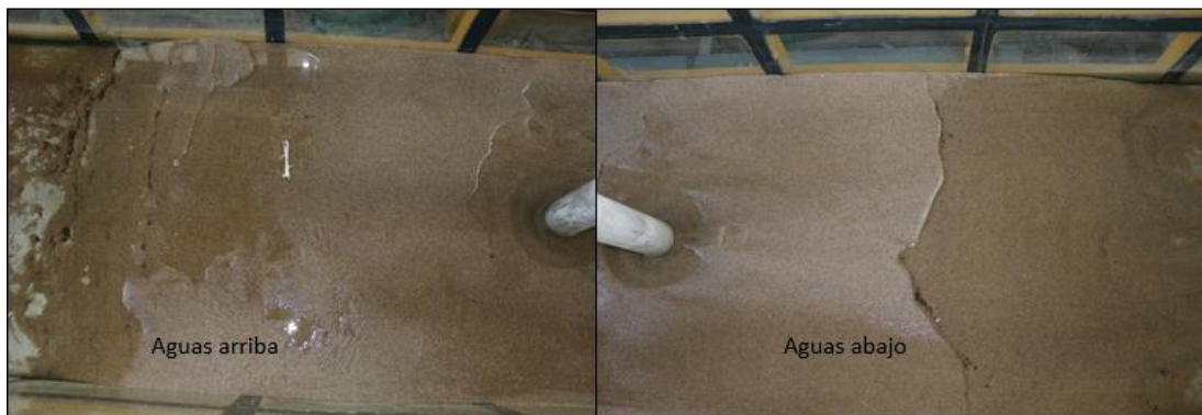
Figura 3-18 Socavación en pila circular sin paneles
