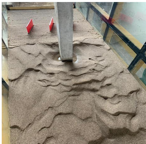
Figura 3-12 Socavación alrededor de la pila cuadrada sin paneles
