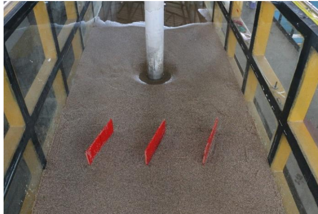
Figura 3-19 Paneles colocados con pila circular
