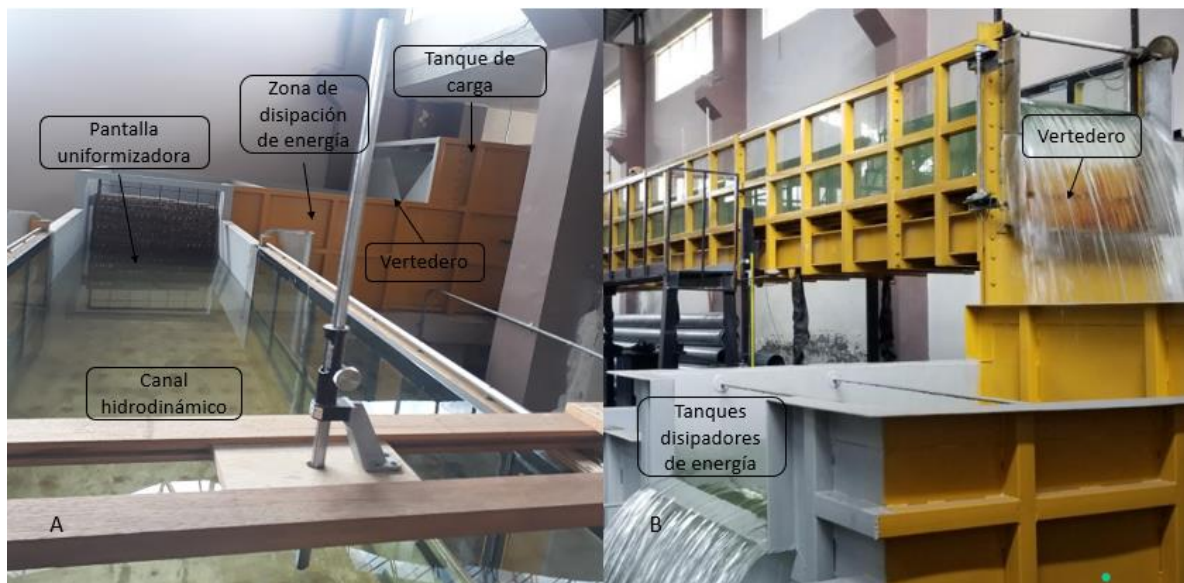
Figura 3-3-2 Instalaciones canal CIERHI-EPN a) aguas arriba, b) aguas abajo
