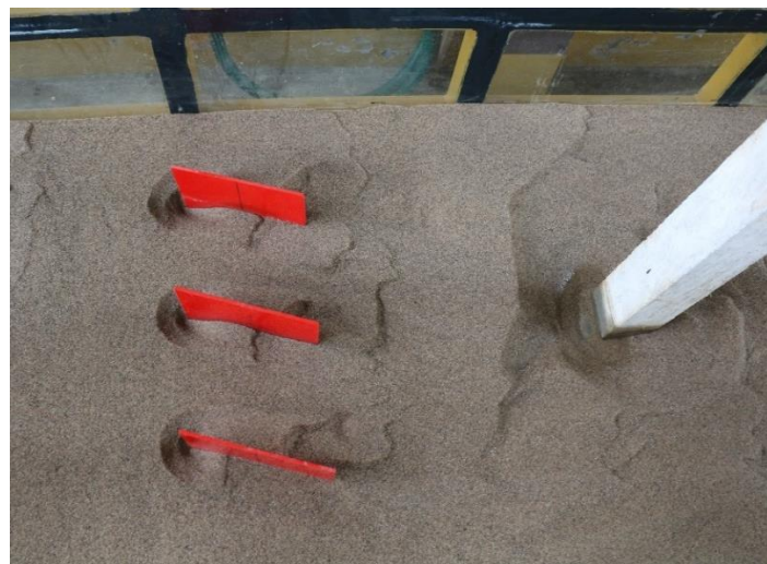
Figura 3-17 Socavación en pila cuadrada con paneles sumergidos
