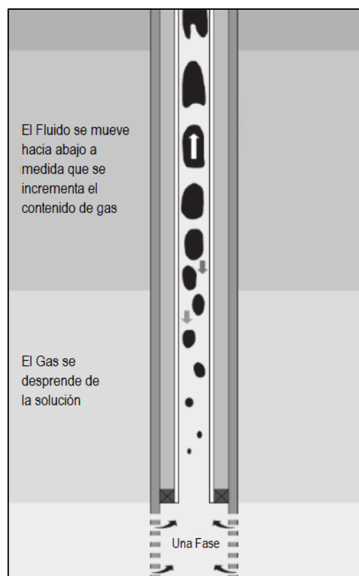
Figura 22. Esquema de Flujo multifásico, Almacenamiento variable Fuente: Modificado de Pressure Transient Formation and Well Testing (Kuchuk, Onur, & Hollaender, 2010)
