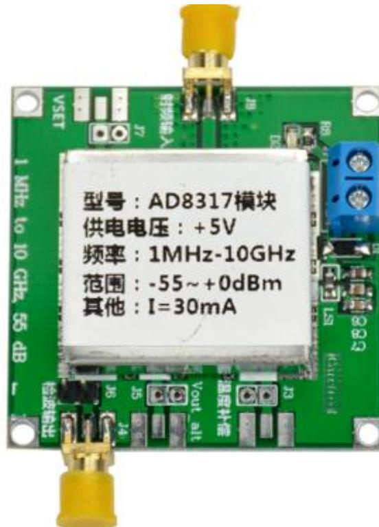
Figura 1.15: Medidor de potencia RF [21]
