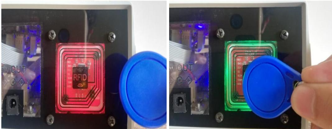
**Figura 3.44:** Prueba de control de acceso
