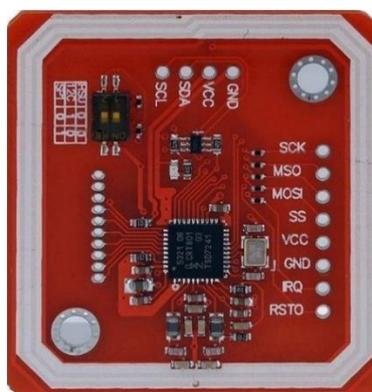
**Figura 1.13:** Módulo RFID PN532 [18]
