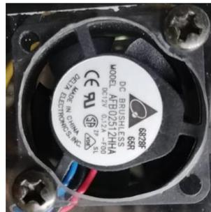
**Figura 1.32:** Ventilador de alta presión [36]
