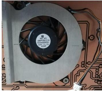
**Figura 1.31:** Ventilador centrífugo [36]
