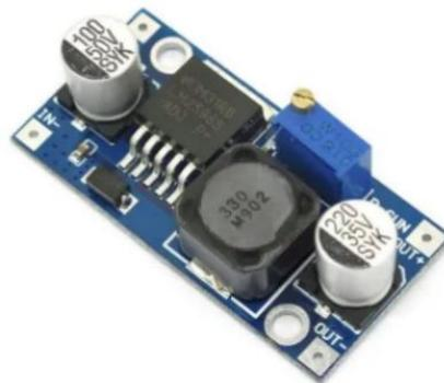
**Figura 1.25:** Módulo regulador de voltaje LM2596 [30]
