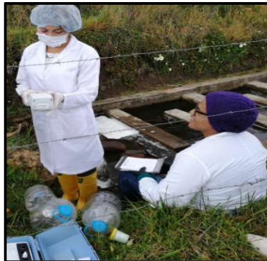
Figura 14 Medición de turbiedad
