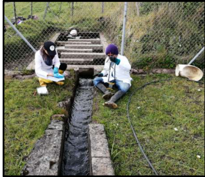
Figura 59 Muestreo en el P1 Pretratamiento (Serpentín)
