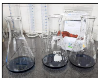
Figura 3.41 Determinación de Acidez (Flores & Calderon, 2020).
