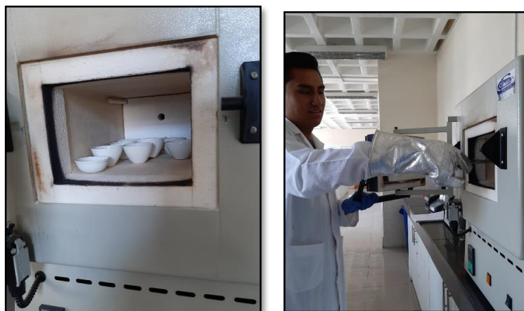
Figura 3.42 Determinación de sólidos Totales (Flores & Calderon, 2020).
