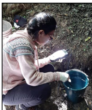
Figura 3.22 Medición del Oxígeno Disuelto (Flores & Calderon, 2020).
