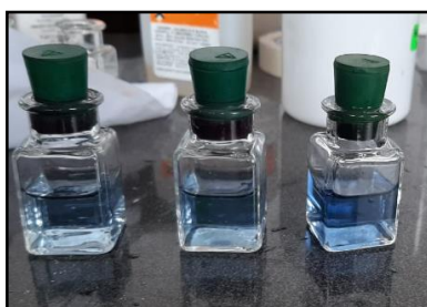
Figura 3.25 Determinación de Nitratos (Flores & Calderon, 2020).
