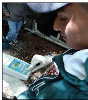
Figura 3.21 Medición de la Turbiedad (Flores & Calderon, 2020).
