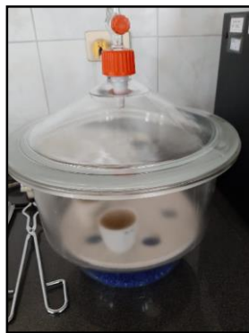
Figura 3.46 Determinación de sólidos volátiles (Flores & Calderon, 2020).
