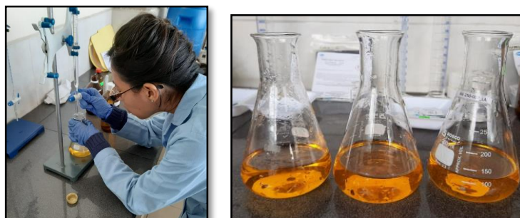
Figura 3.39 Determinación de la alcalinidad (Flores & Calderon, 2020).
