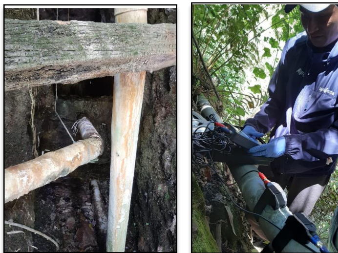
Figura 3.53 Determinación del caudal (Flores & Calderon, 2020).
