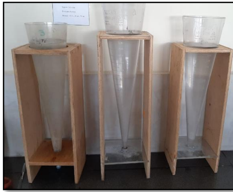
Figura 3.44 Determinación de sólidos sedimentables (Flores & Calderon, 2020).
