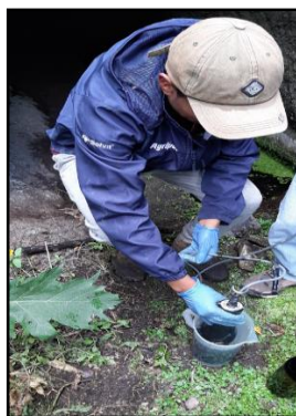
Figura 3.20 Medición de la conductividad (Flores & Calderon, 2020).
