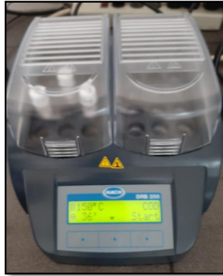
Figura 3.23 Medición de la demanda química de oxígeno (DQO) (Flores & Calderon, 2020).
