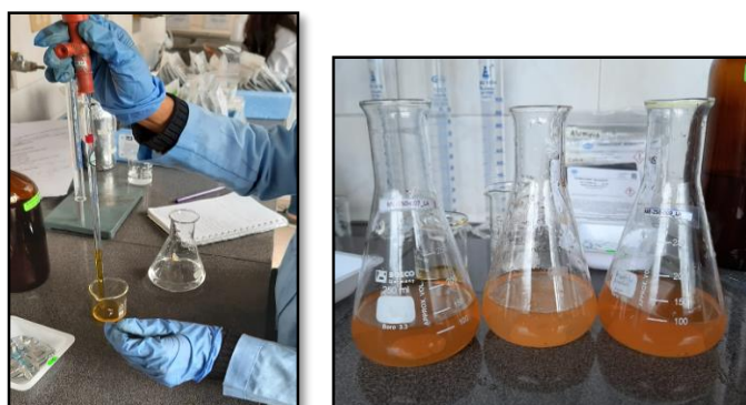
Figura 3.36 Determinación de Cloruros (Flores & Calderon, 2020).
