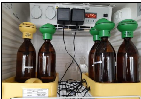
Figura 3.24 Medición de la Demanda biológica de oxígeno (DBO 5 ) (Flores & Calderon, 2020).
