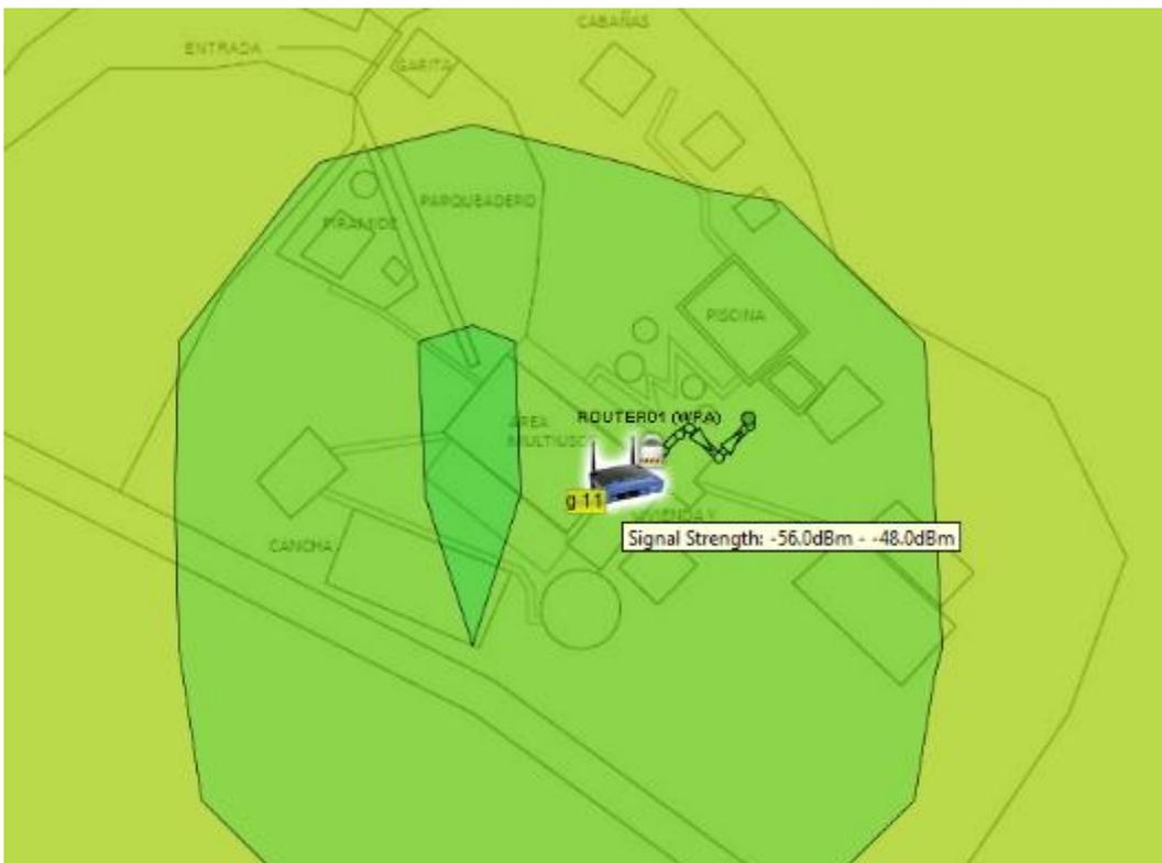
Figura 2.14 Site Survey con el AP en la zona de bar.
