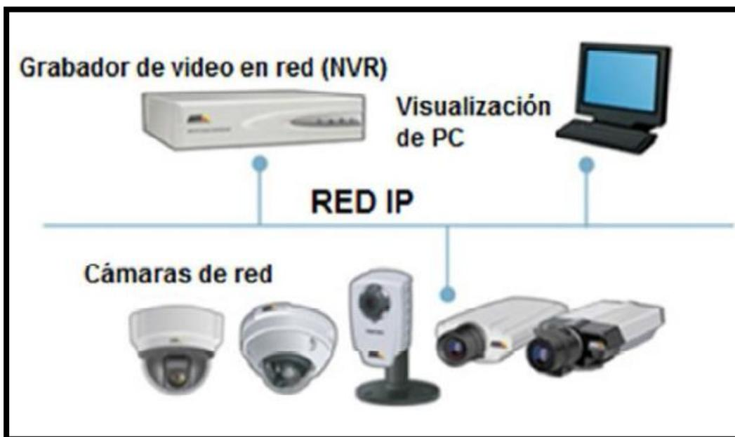
Figura 1.7 Esquema de conexión de un NVR [8]
