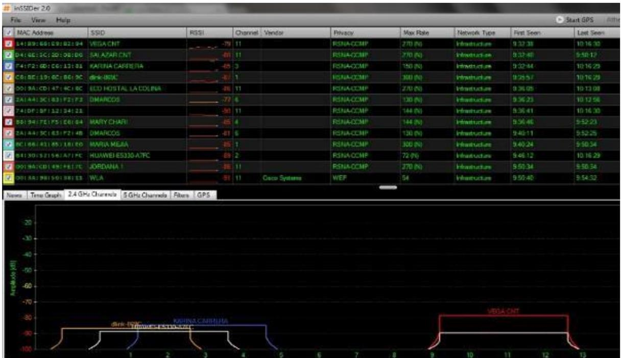
Figura 2.8 Redes inalámbricas detectadas en el espacio cubierto multiusos
