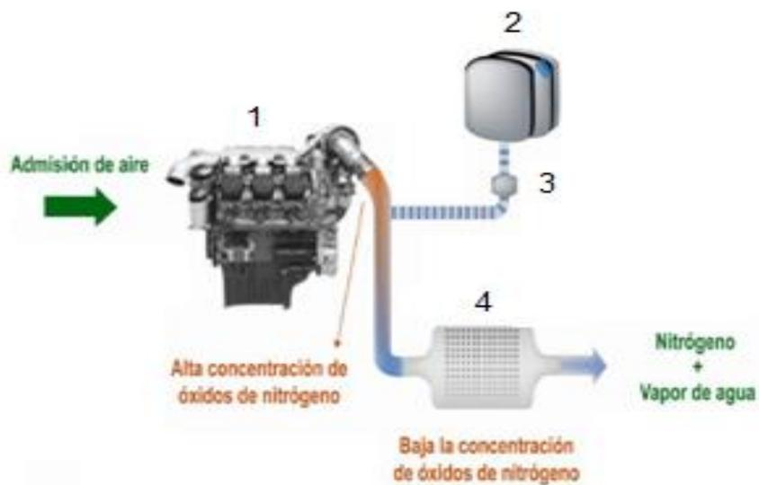
Figura 1.19. Sistema de Reducción Catalítica Selectiva (SCR).
