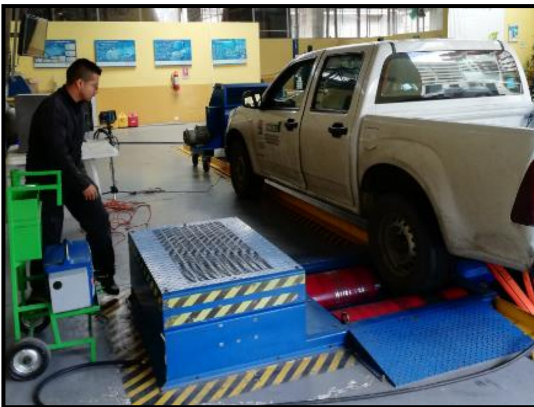
Figura AX. 4. Preparación para el desarrollo del ensayo de laboratorio lug down
