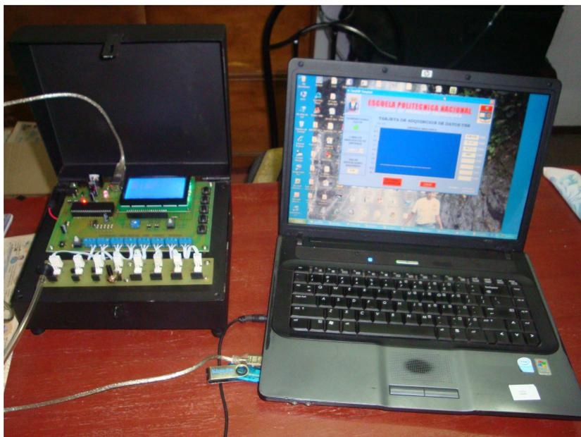
*Figura 2.31: Conexión completa del sistema de adquisición de datos.*
