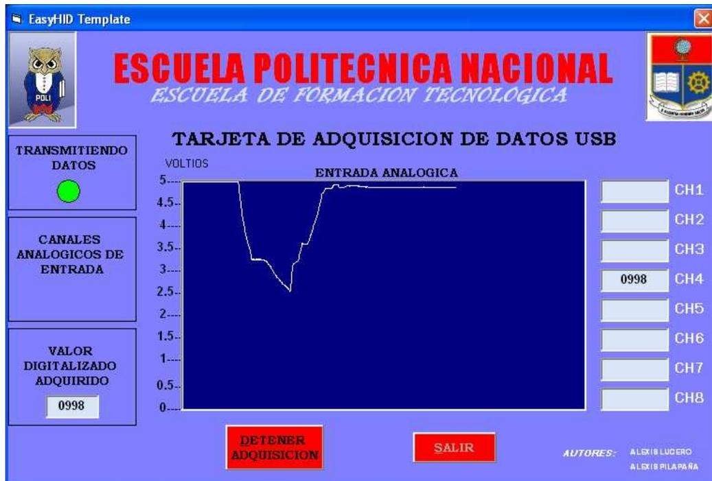
Figura 4.7: Dato obtenido al variar el potenciómetro.
