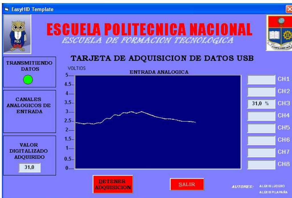
Figura 4.6: Visualización del valor de humedad en la interfaz gráfica.
