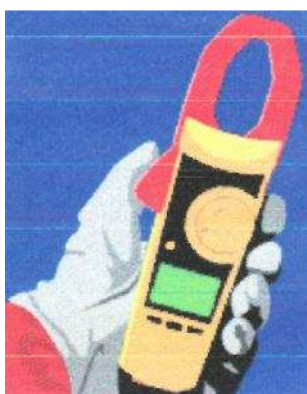
Figura 4.12. Multímetro o pinza amperimétrica.
