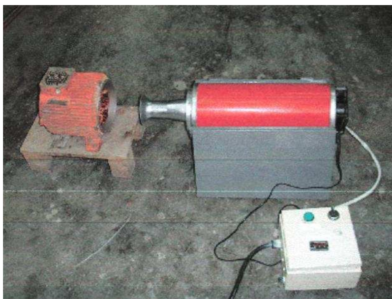
Figura 4.12. Secador a aire forzado con control de temperatura automático y estator.
