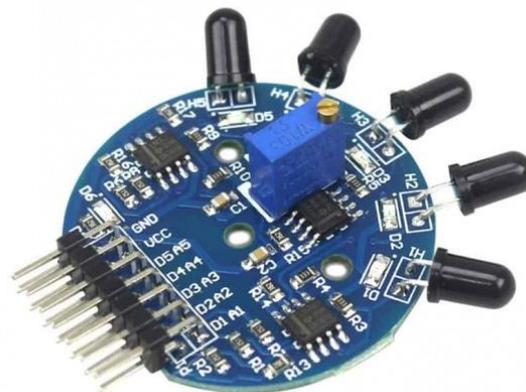
**Figura 1.9:** Sensor flama 5 canales [28]
