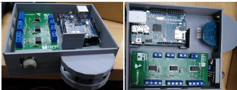
**Figura 3.23:** Case del Arduino del generador
