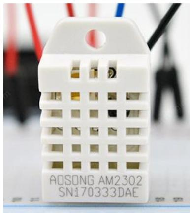
**Figura 1.6:** Sensor DHT22 [19]
