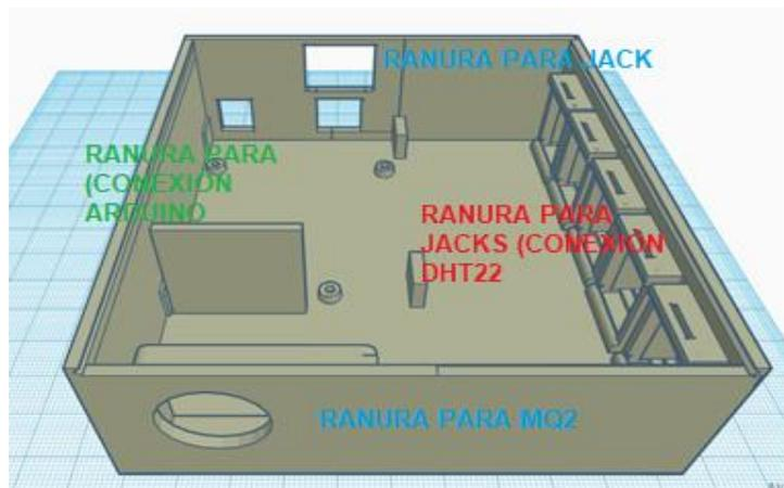
**Figura 3.14:** Case Arduino nodo
