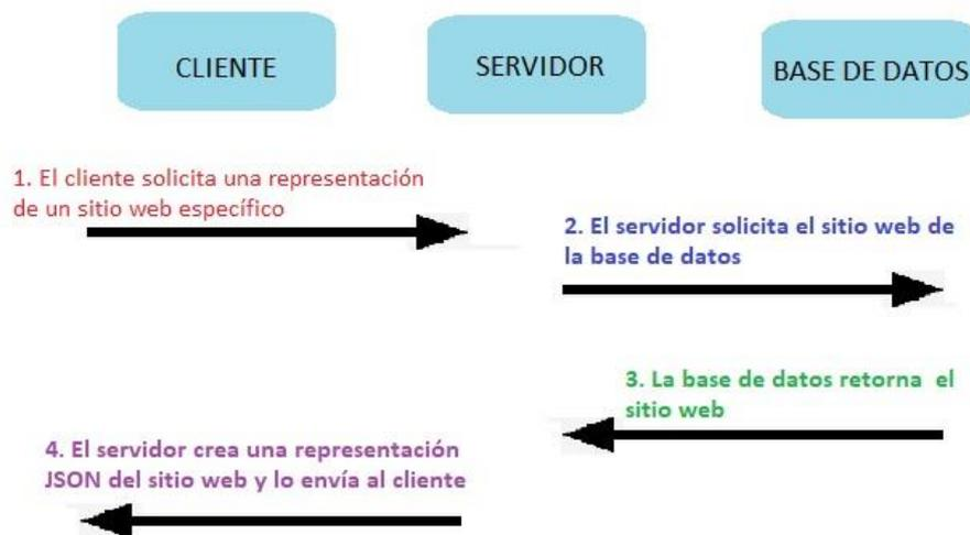
**Figura 1.11:** Ejemplo de funcionamiento REST [36]
