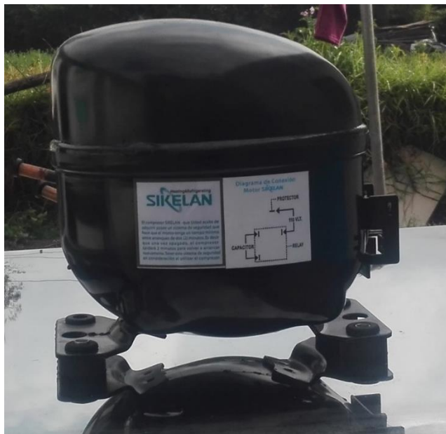
Figura 3.15. Compresor Sikelan de 1/3 [HP]. Fuente: Propia.
