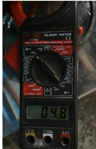
Figura 3.40 Consumo de amperaje del compresor. Fuente: Propia.
