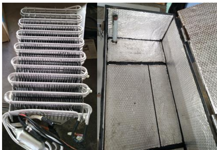
Figura 3.16. Evaporador de tubos con aletas y contenedor del equipo.
