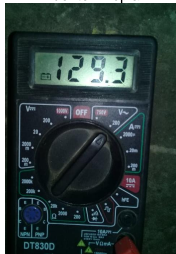
Figura 3.41 Voltaje medido en el compresor. Fuente: Propia
