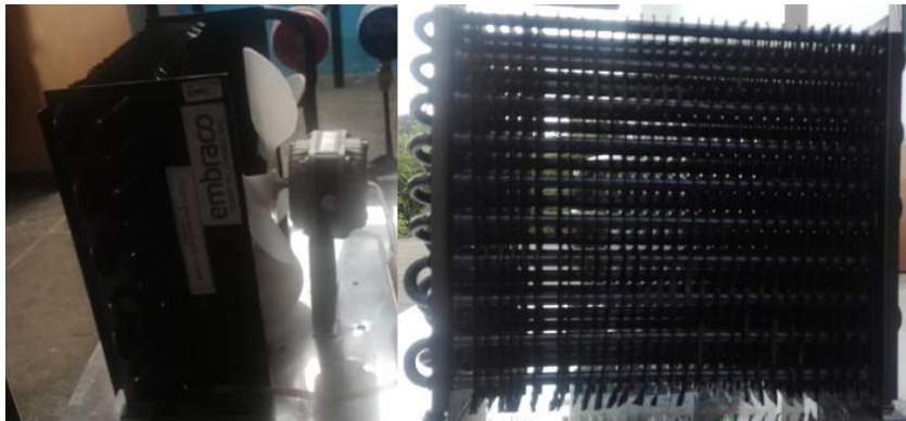
Figura 3.17. Unidad condensadora y el ventilador en la parte inferior de la cámara. Fuente: Propia
