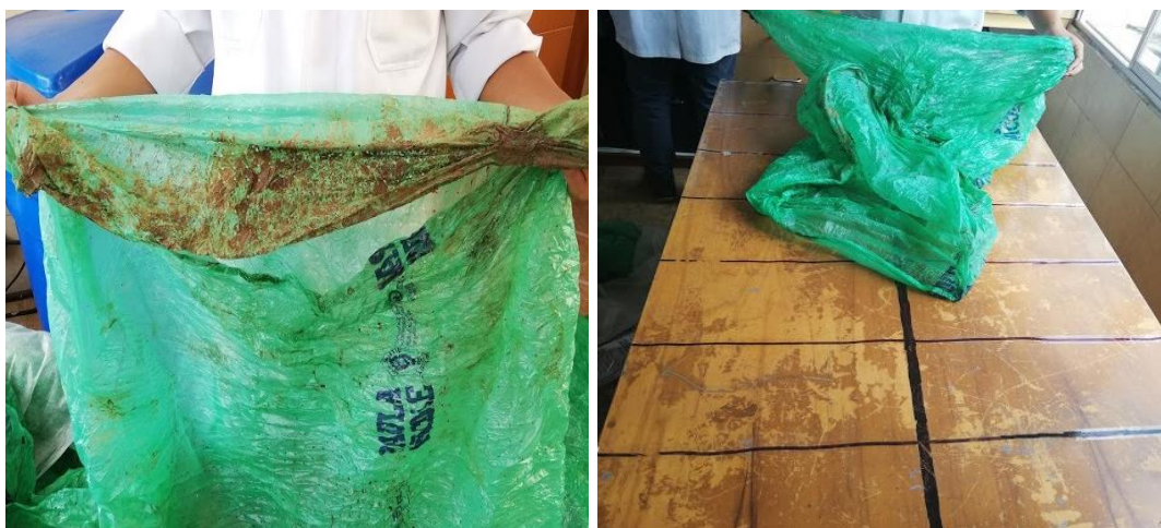
Figura 10. Daños físicos en las bolsas plásticas. Elaborado por: Cando e Inga, 2019
