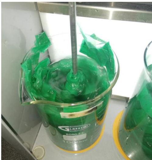
Figura 15. Muestras plásticas enredadas en el eje del agitador
