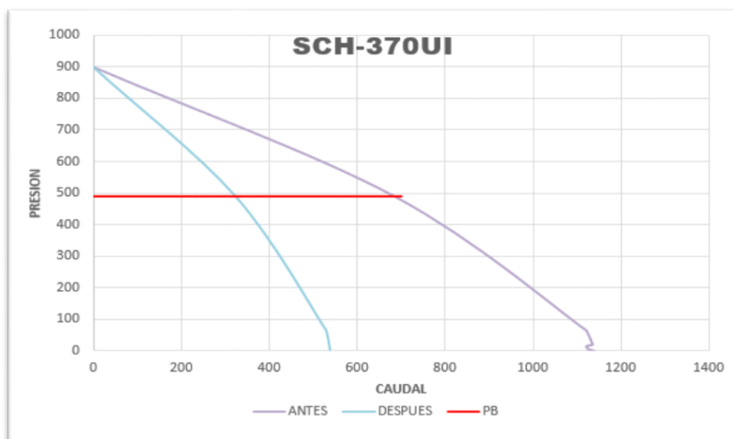
Figura 39: Curvas IPR antes y después del FH del pozo SCH-370UI Elaborado por: Chango, 2019 Fuente: (Oil Field Manager OFM, 2019)
