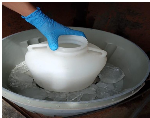
Figura 67. Colocación de hielo en la "bodega" del equipo
