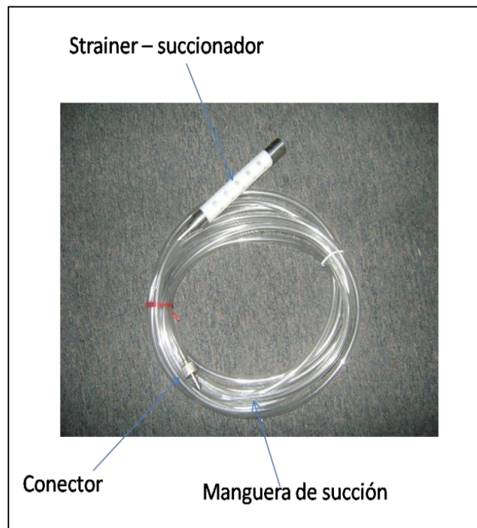
Figura 17. Manguera de succión y strainer
