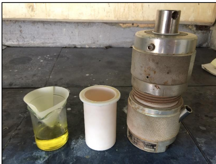
Figura 3.4: Reactor autoclave usado en la lixiviación de PGMs
