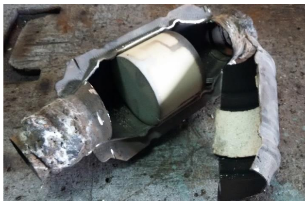
Figura 3.1: Proceso de apertura de la carcasa del convertidor catalítico para la obtención del monolito
