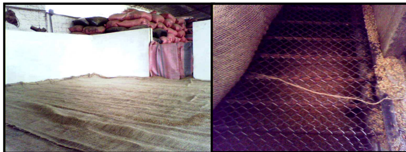
Figura 12. Piso falso de un secador de lecho fijo para arroz
