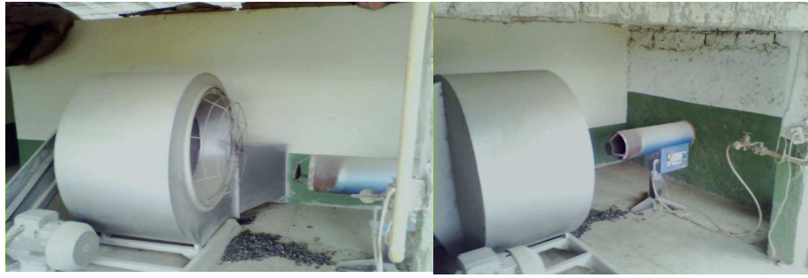
Figura 15. Sistema de combustión accionado por quemadores de GLP para secado de granos.
