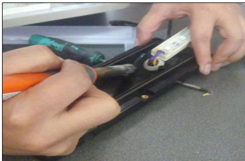
Figura 3.42 Colocación del módulo RGB dentro de la carcasa.
