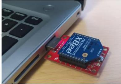
**Figura X.12** Conexión de módulo Xbee Coordinador.
