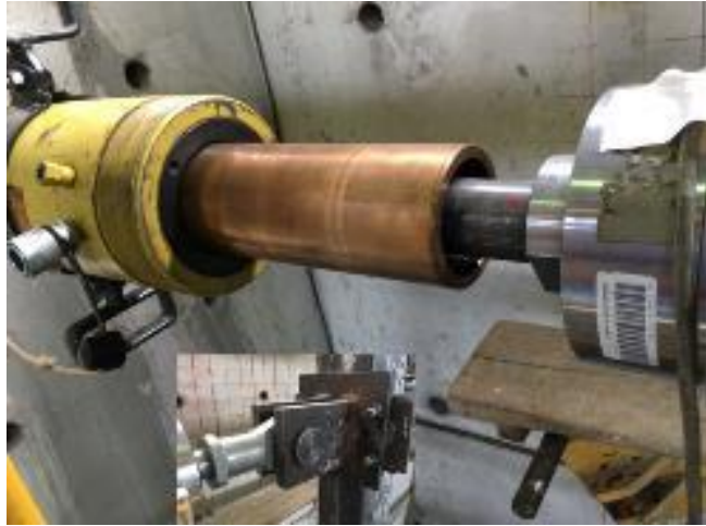
FIGURA 4.12 Gata hidráulica con pistón de carga
