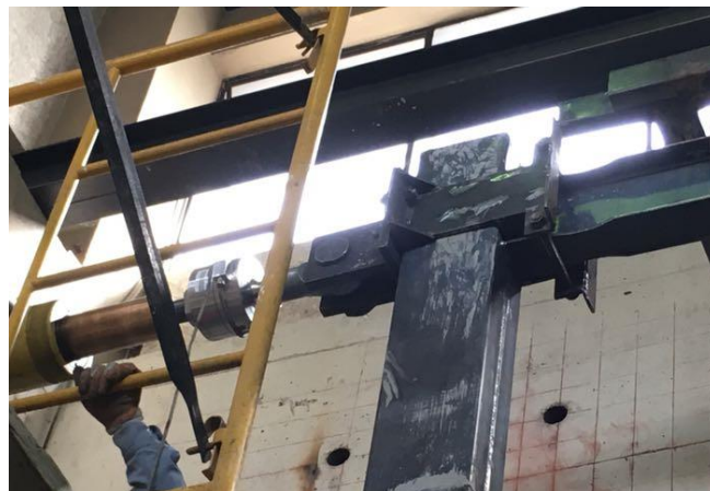
FIGURA 4.15 Sujeción de gata y pistón con los pórticos a ensayar
