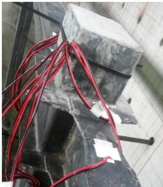
FIGURA 4.32 Colocación de strain gauges en laboratorio (nudo central superior)
