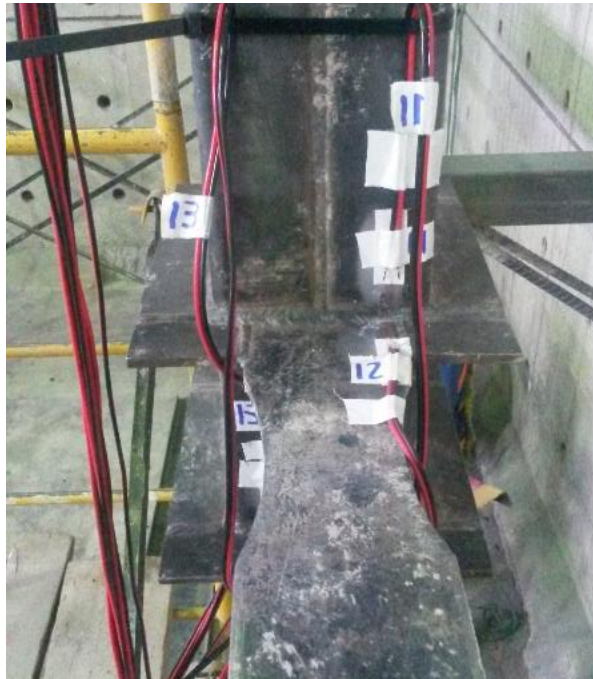
FIGURA 4.25 Colocación de strain gauges en laboratorio (nudo central inferior)
