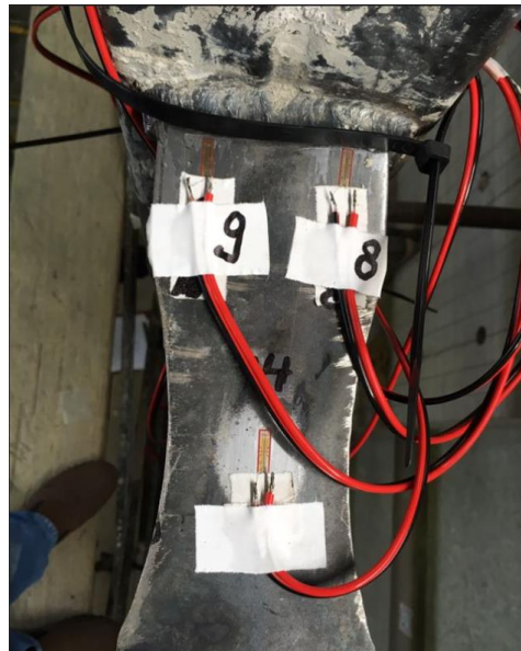
FIGURA 4.18 Colocación de strain gauges en laboratorio (nudo central superior)
