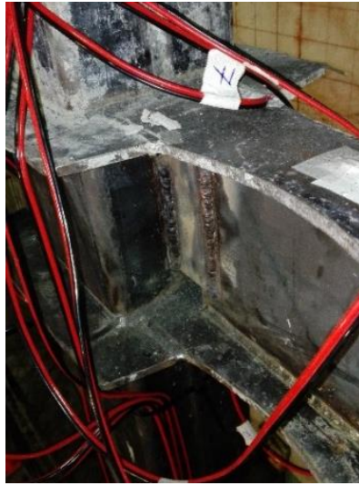
FIGURA 4.31 Colocación de strain gauges en laboratorio (nudo central inferior)
