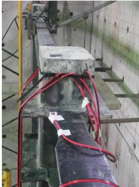
FIGURA 4.24 Colocación de strain gauges en laboratorio (nudo central superior)
