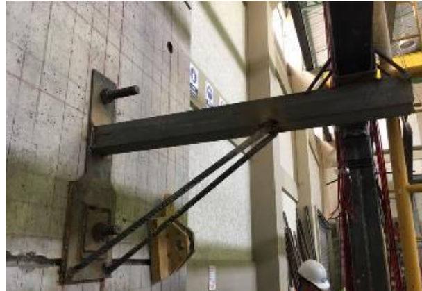
FIGURA 4.14 Arriostramiento lateral de pórtico
