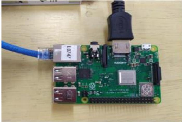
*Figura C1.4 Conexión Puerto HDMI y Ethernet de un RPI*
