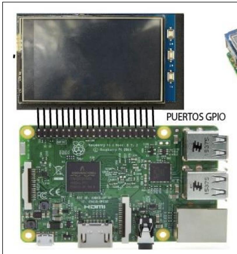
*Figura 3.1 Raspberry Master conectado a LCD de 3,5"*
