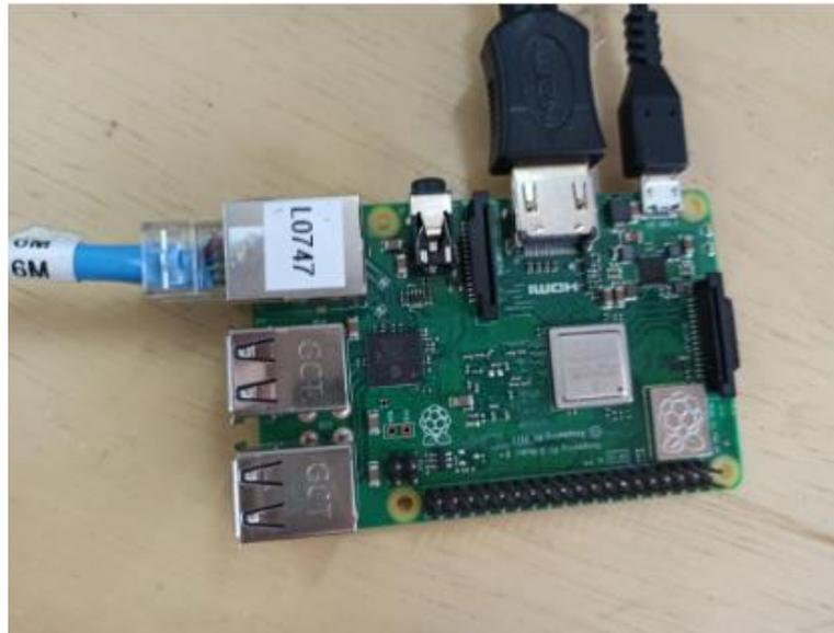
*Figura C1.5 Conexión Puerto HDMI, Ethernet y Corriente en RPI*
