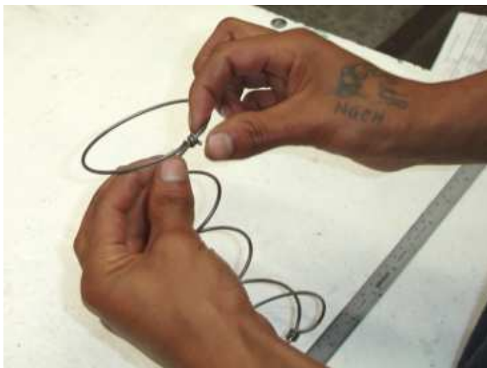
Foto 7: Comprobación de la longitud del nudo, número de vueltas y ajuste o apriete del nudo
