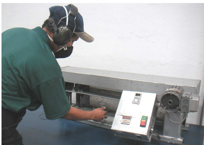
Foto 18: Realización de ensayo de compresión para la comprobación de pérdida de altura por fatiga en el resorte bonnell
