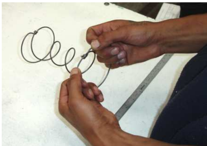
Foto 8: Comprobación del ajuste o apriete del nudo
