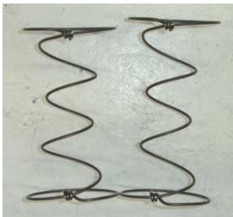
Foto 16: Pérdida de altura en el resorte por asentamiento
