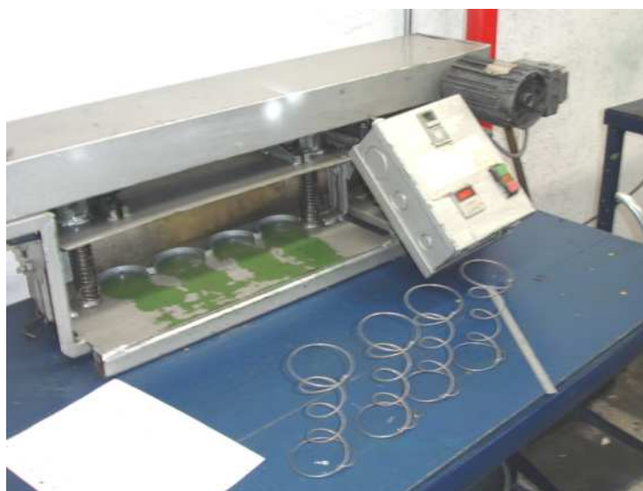
Foto 17: Máquina para realización de ensayo de compresión en el resorte (pérdida de altura por fatiga)
