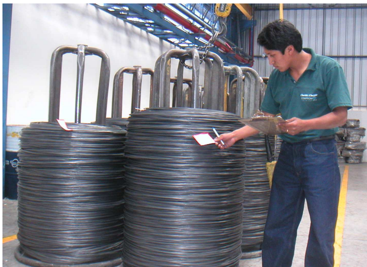
Foto 1: Comprobación de requisitos físicos del alambre.
