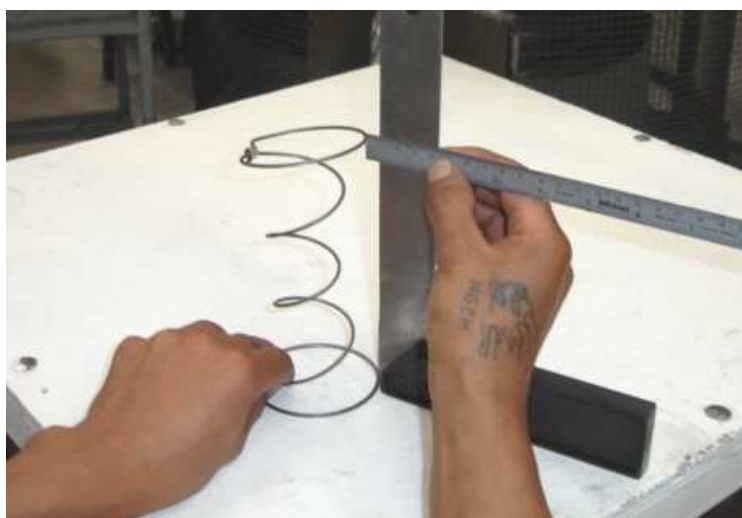
Foto 12: Comprobación de la inclinación del resorte a 180^\circ
