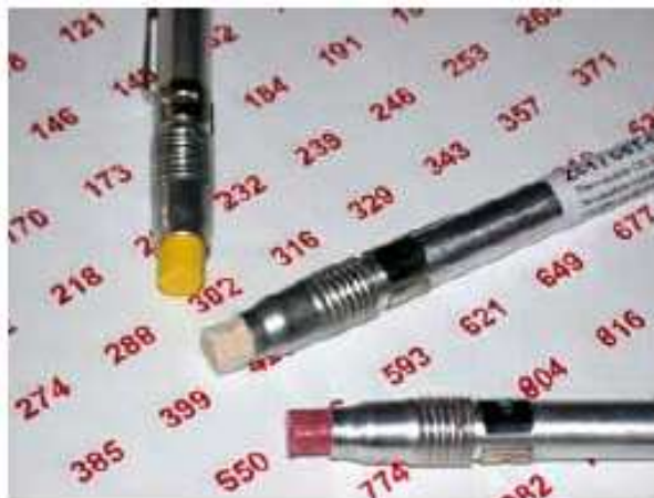
Fig. 3.22 Crayones o tizas térmicas para comprobación de temperatura
