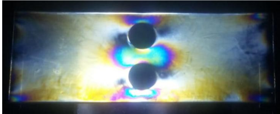
Figura 3.6. Probeta con dos agujeros orientados verticalmente, carga 38Kg.
