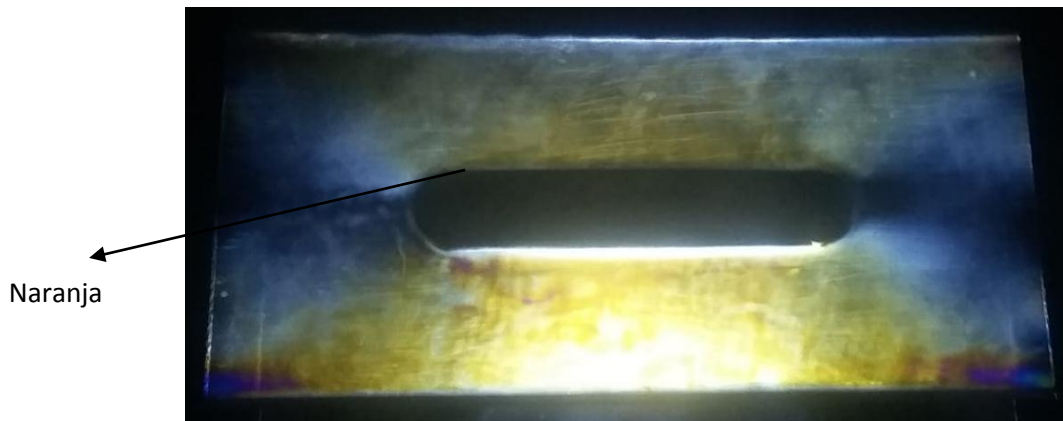
Figura 3.7. Probeta con ranura central, carga 20 Kg.
