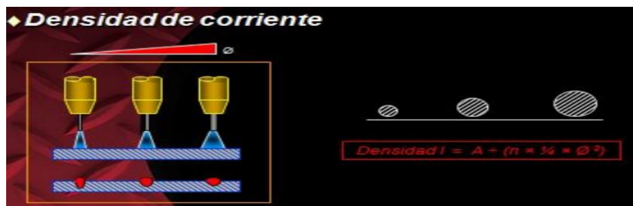
Figura 1.17. Diámetro del electrodo en función de la densidad de corriente.
