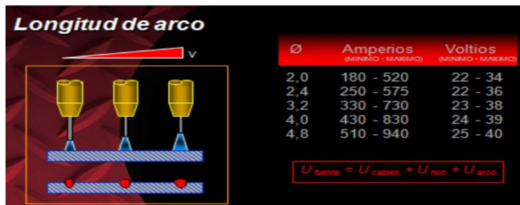
Figura 1.16. Longitud de Arco en soldeo con SAW.
