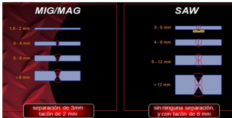
Figura 1.21. Preparación de diseño de junta SAW y GMAW. Fuente: (Cesol-Soldeo por Arco Sumergido, 2012, p.47)
