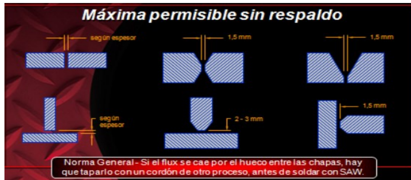
Figura 1.22. Máximo permisible sin respaldo en SAW. Fuente: (Cesol-Soldeo por Arco Sumergido, 2012, p.48)
