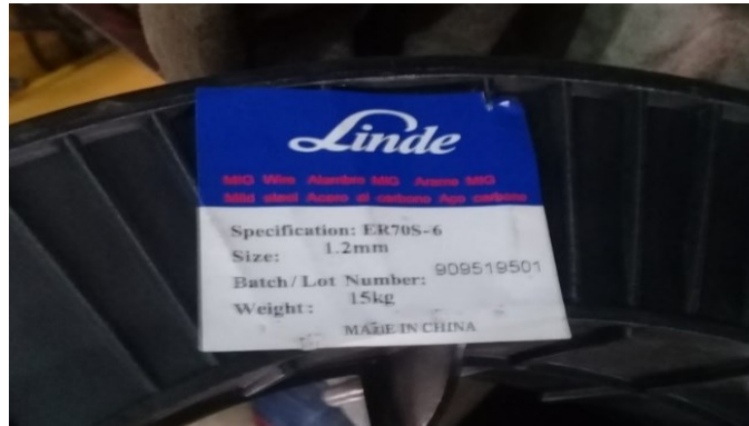
Figura 1.30. Alambre macizo de acero al carbono utilizados en la planta SEDEMI. Fuente: (propia)
