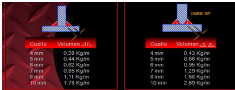
Figura 1.13. Cálculo de material de soldadura depositado en junta a tope T y T con chaflán. Fuente: (Cesol-Soldeo por Arco Sumergido, 2012, p.27)
