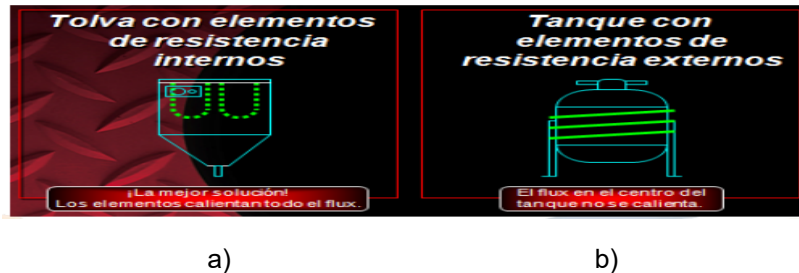
Figura 1.9. Equipos de alimentación de Fundente: a) Tolvas, b) Tanques. Fuente: (Cesol-Soldeo por Arco Sumergido, 2012, p.26)
