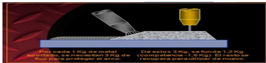
Figura 1.10. Equipo de recuperación de Fundente. Fuente: (Cesol-Soldeo por Arco Sumergido, 2012, p.26)
