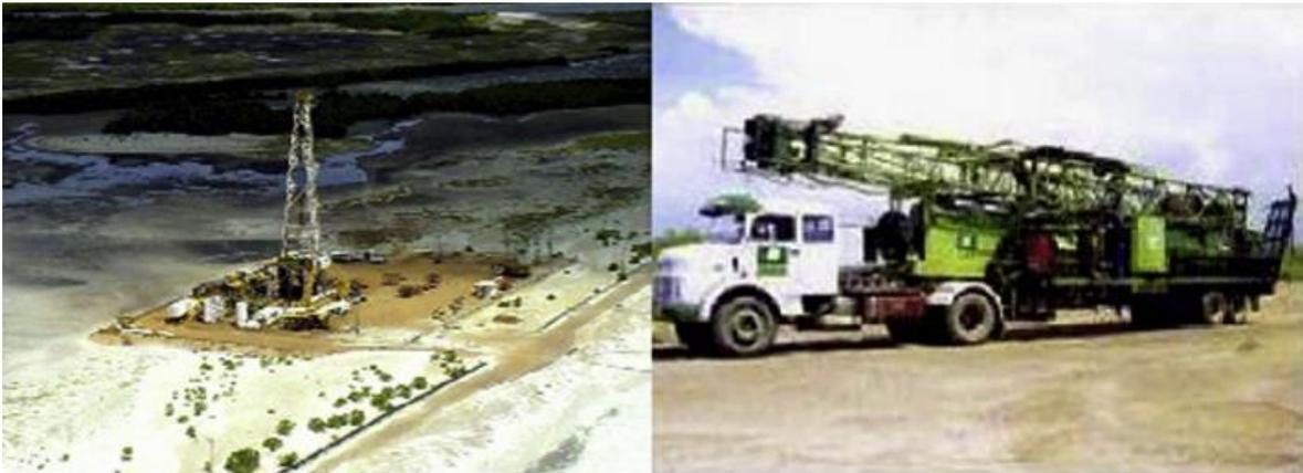
**Figura 14** - Torre de reacondicionamiento
