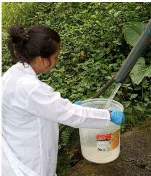
Figura 3. 8. Medición de caudal por método volumétrico
