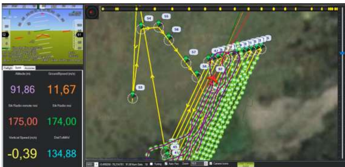
Figura 31 – Captura de pantalla de software Mission Planner en el sobrevuelo del dron
