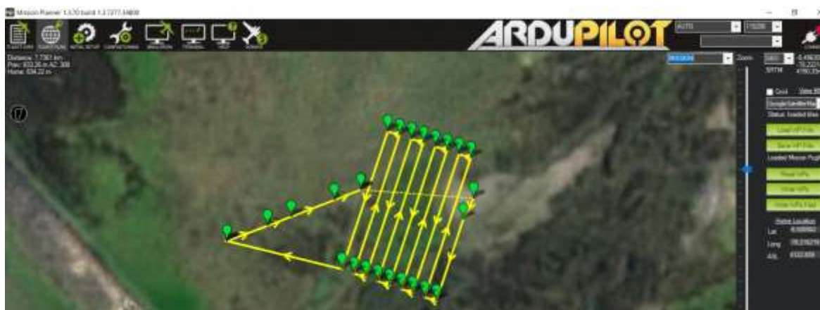
Figura 22 – Ejemplo de misión de vuelo en el software “Mission Planner”
