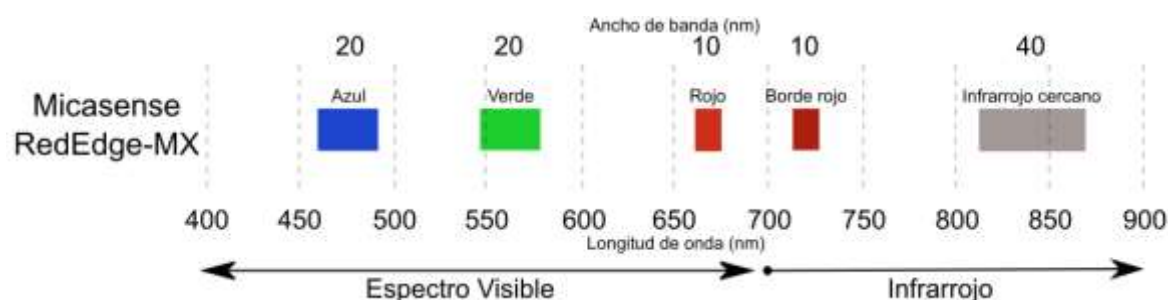
Figura 6 – Bandas espectrales de la cámara multispectral Micasense RedEdge – MX
