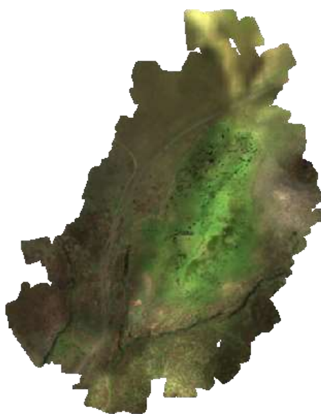
Figura 39 – Ortomosaico RGB obtenido a través del software Agisoft Metashape
