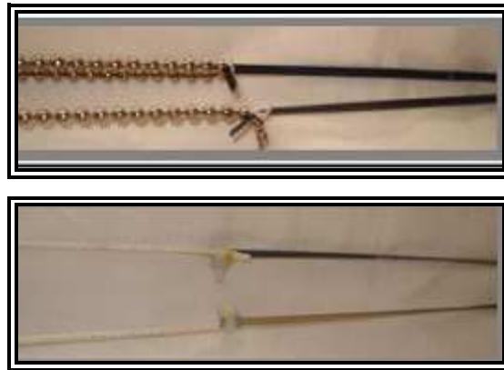
Figura 3.2 Cadenas mixtas para el movimiento de las persianas.
