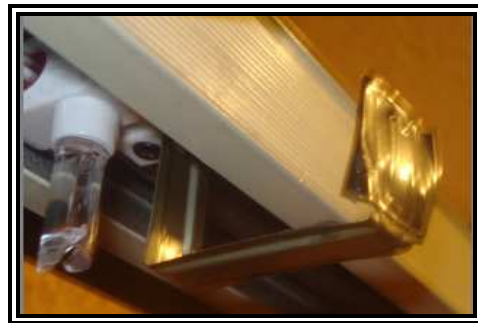
Figura 3.5 Mecanismo de accionamiento de los opto-acopladores.
