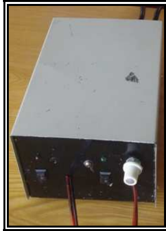
Figura 3.11 Resultado final de la fuente de voltaje y la fuente de alimentación variable.
