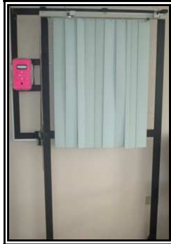
Figura 3.17 Resultado final del sistema de apertura y cierre de persianas verticales.
