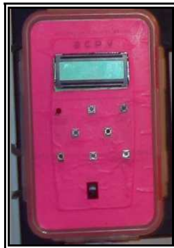
Figura 3.10 Caja donde se coloca la placa principal y servirá para el panel de control.
