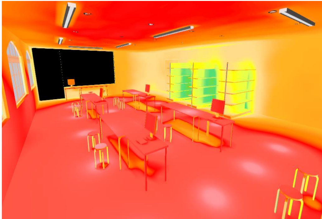
Figura 3.7: Luxes en escala de colores por áreas (vista lateral derecha).
