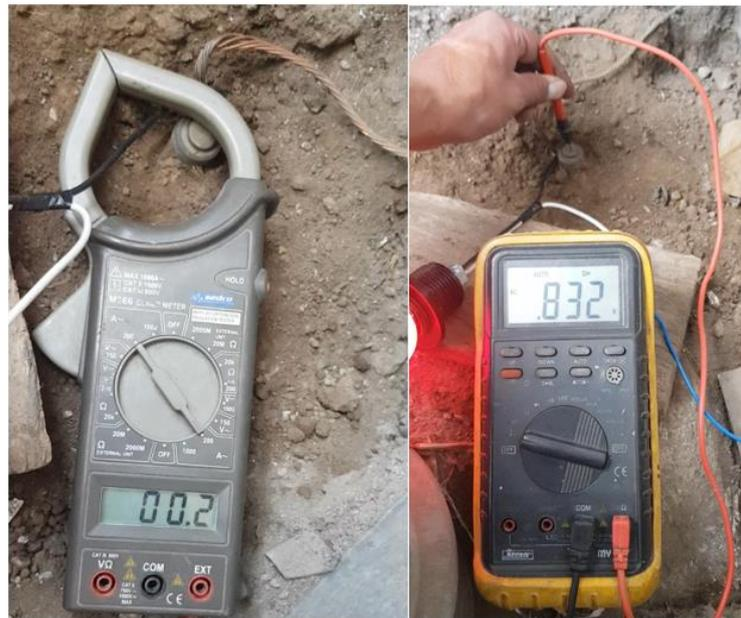
**Figura 3.18:** Medición de parámetros eléctricos en suelo
