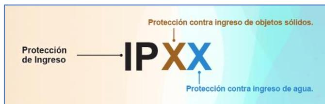
**Figura 3.5:** Nomenclatura del Índice de Protección (Ingress Protection)
