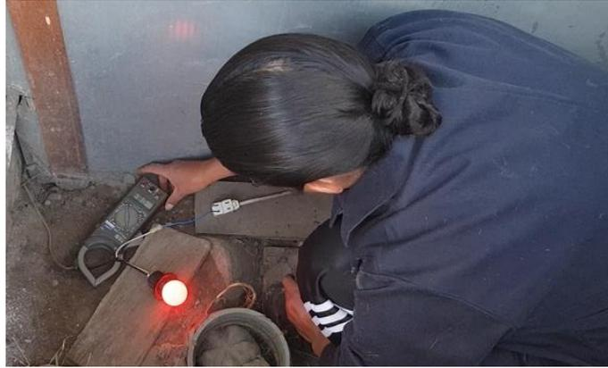
**Figura 3.17:** Instalación de equipos para medición de resistencia del suelo.
