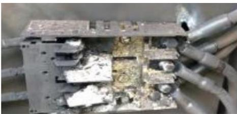
**Figura 32:** Contactos sulfatados
