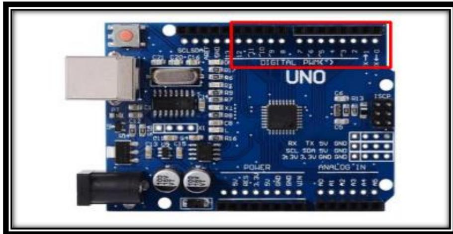
Figura 1.9: Tarjeta Arduino UNO (Entradas-salidas digitales) [6]
