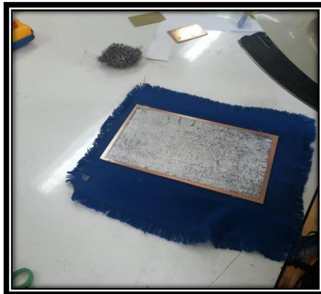
**Figura 3.54: Planchado del diseño en la placa.**
