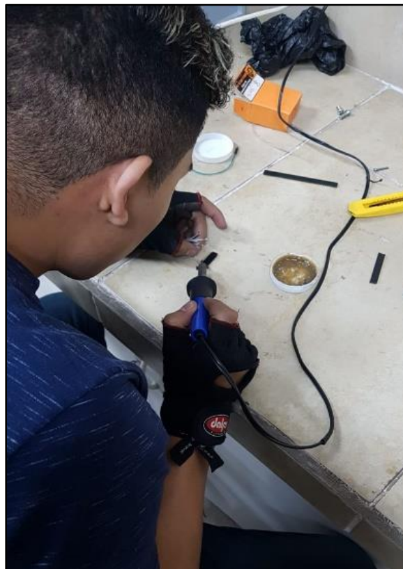
Figura 3.25: Suelda de puntas de conexión para pines de Arduino.
