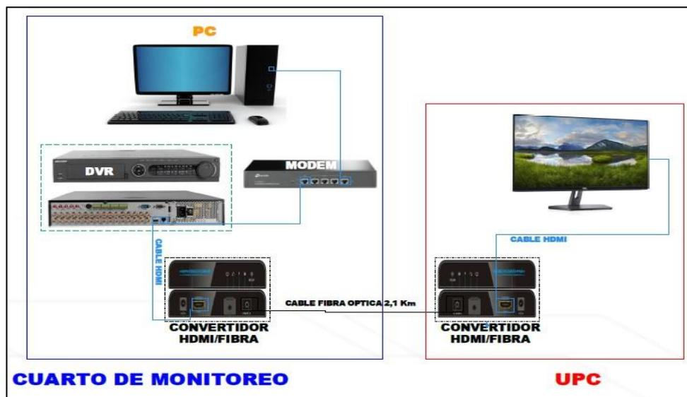
Figura 3.13 Diagrama lógico del enlace a una distancia de 2,1Km.
