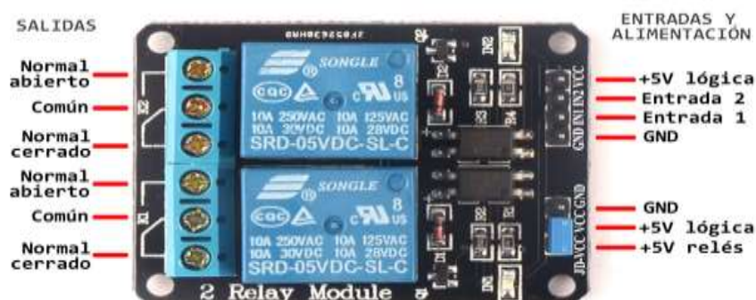
Figura 1.5: Contactos del módulo relé [7]
