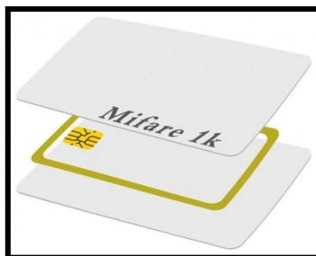
Figura 1.7: Componentes tarjeta MIFARE . [9]
