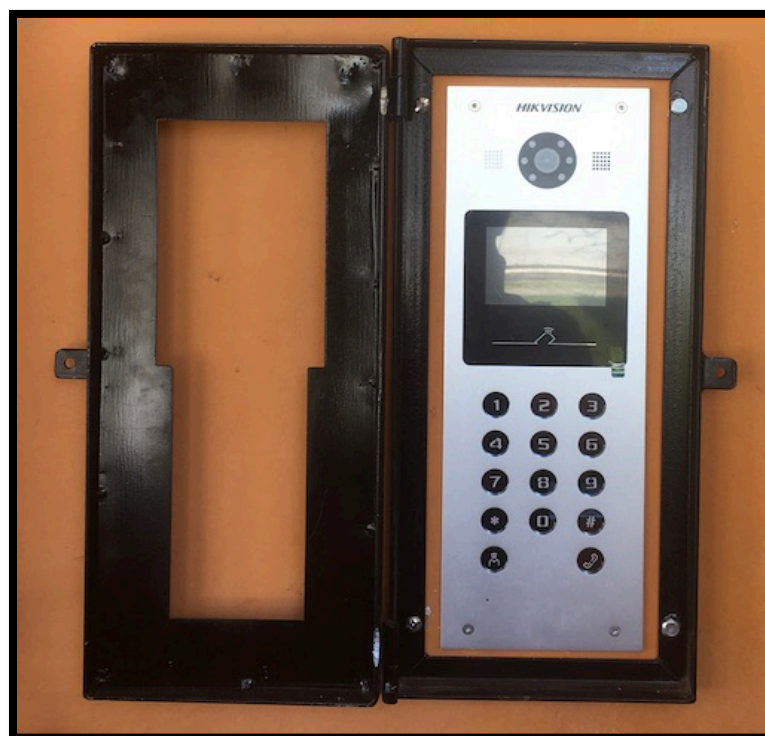
Figura 3.22: Montaje de protección de placa externa.
