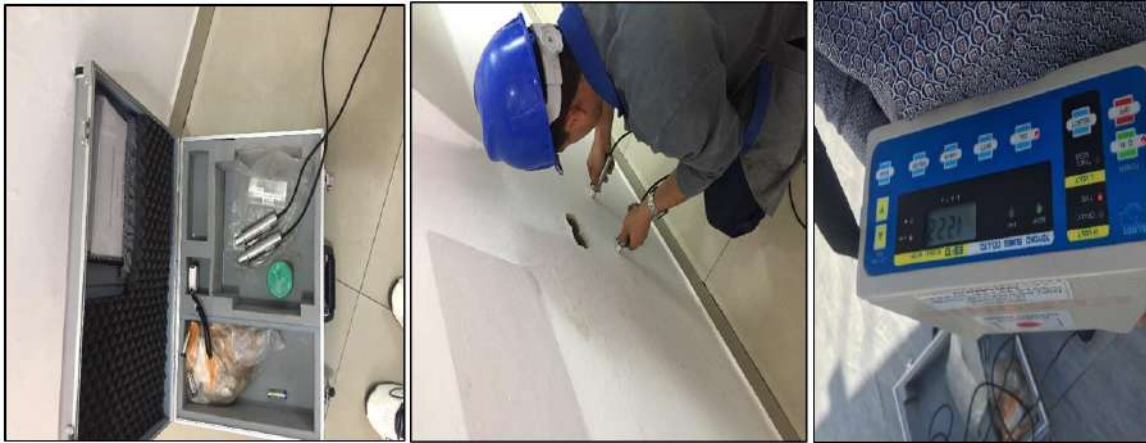
Figura 2. 7 Ensayo de velocidad sónica en hormigón IN SITU. Fuente: Chávez y Gómez.
