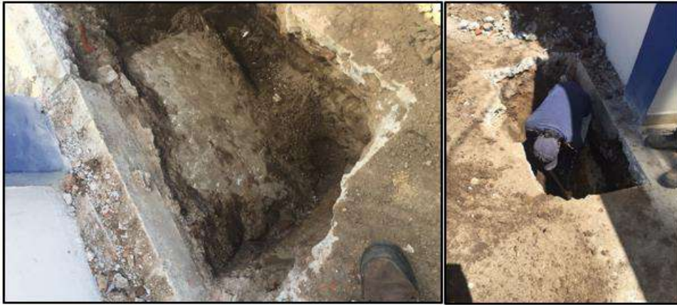
Figura 2. 6 Extracción de muestra para ensayo triaxial.
