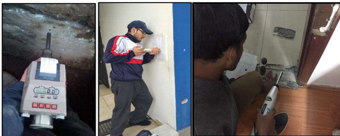
Figura 2. 9 Ensayo utilizando el martillo esclerómetro.
