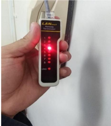
**Figura 3.3.** Testeo del ponchado del cableado
