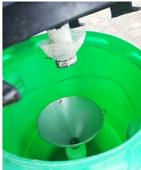
Figura 3.20 Malla móvil en el tanque de almacenamiento
