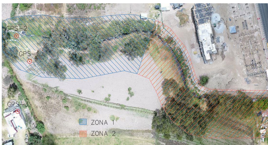
Figura 3.10 Puntos de control y áreas de levantamiento por tipo de metodología usada Elaboración: Propia
