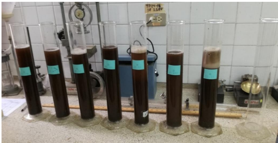
Figura 3.25 Ensayo de granulometría por hidrómetro de las muestras de suelo Elaboración: Propia
