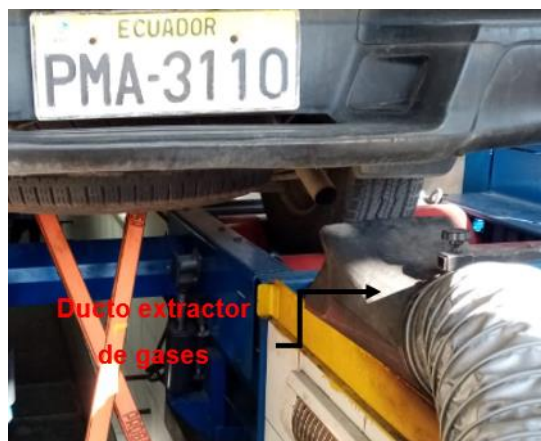
Figura 2.13. Ubicación de la tubería extractora de gas de escape (Fuente: Los Autores, 2020)
