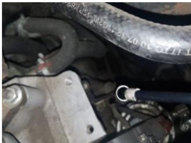
Figura 2.21. Introducción de la tubería hasta la marca. (Fuente: Los Autores, 2020)
