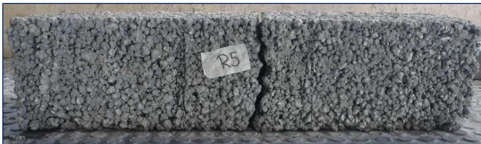
**Figura 22.** Viga fracturada en el tercio medio despues de ensayo a flexión
