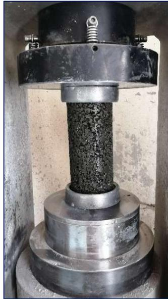
**Figura 17.** Colocación de probeta cilíndrica para ensayo a compresión
