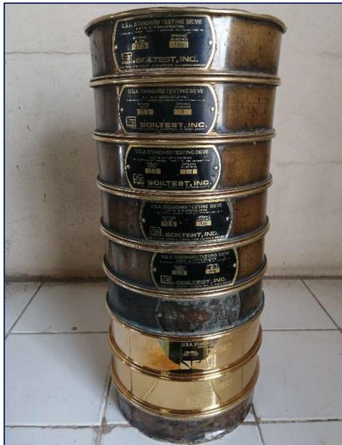
**Figura 8.** Formación de tamices para ensayo granulométrico
