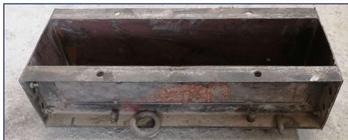
**Figura 13.** Moldes de viga para ensayo a flexión
