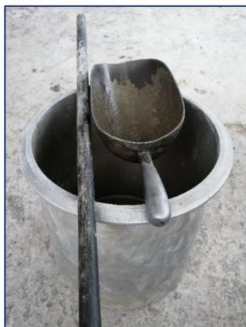
**Figura 10.** Molde para ensayo de densidad aparente
