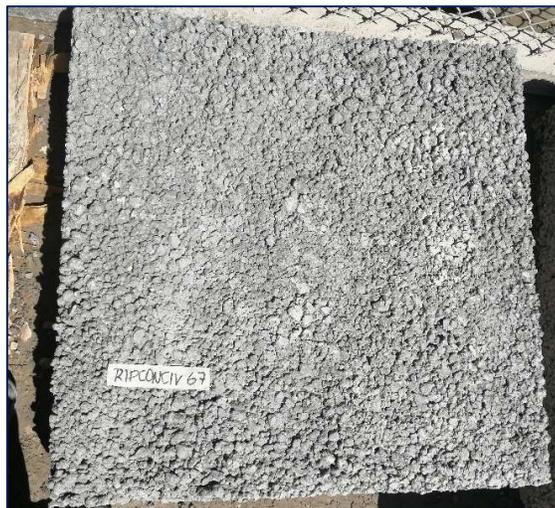
**Figura 3.** Losa de hormigón permeable
