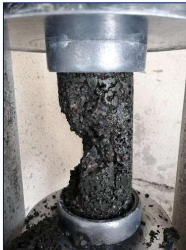
**Figura 19.** Probeta cilíndrica ensayada
