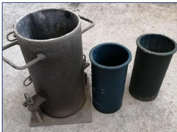
**Figura 12.** Moldes cilíndricos para ensayos a compresión
