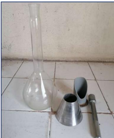
**Figura 9.** Picnómetro, molde y compactador
