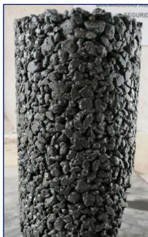
**Figura 5.** Hormigón permeable
