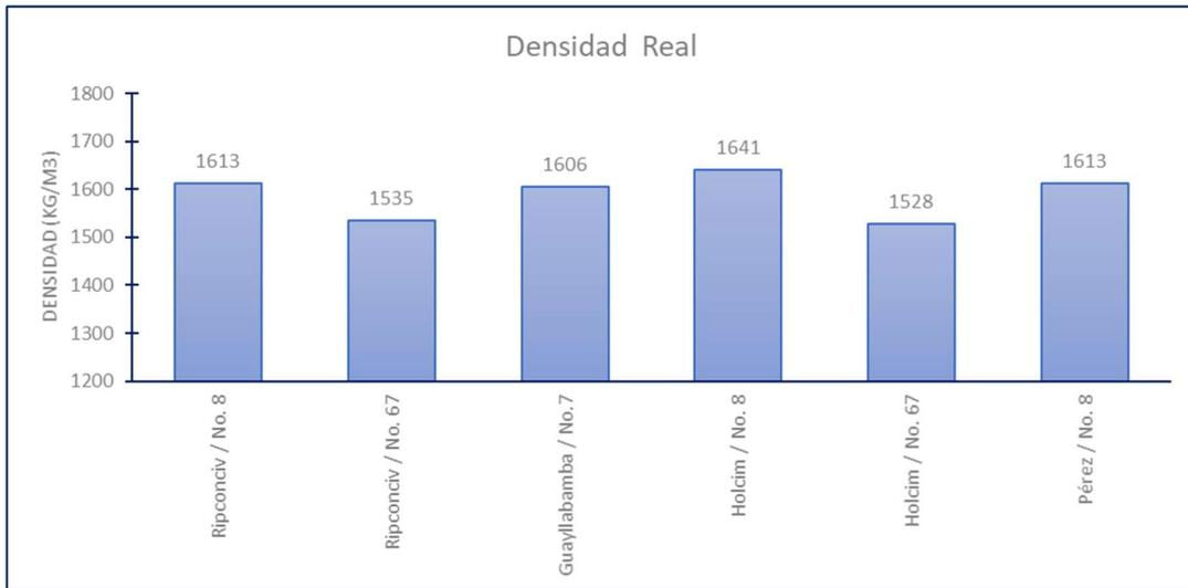
**Figura 28.** Densidad real de diseños de hormigón permeable
