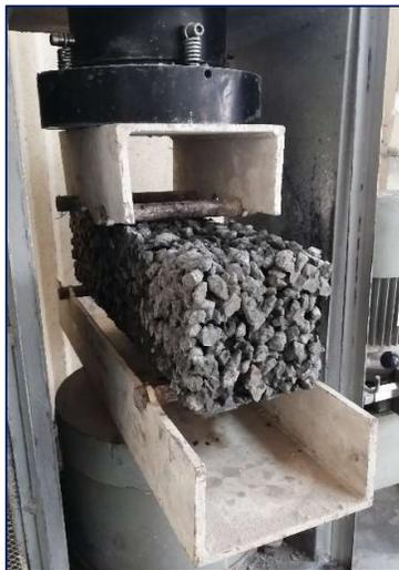
**Figura 21.** Colocación de probeta prismática para ensayo a flexión
